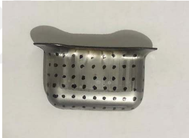
Şekil 5.79. Deneysel alışmalar sonucu elde edilen numunenin kalınlık ölçümüne hazırlanması
