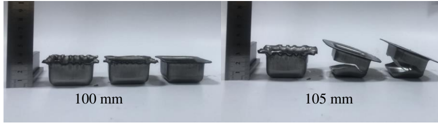
Şekil 5.74. 100 mm ve 105 mm ilkel parça çapında BPK'nın değişimi ile oluşan deformasyonlar
