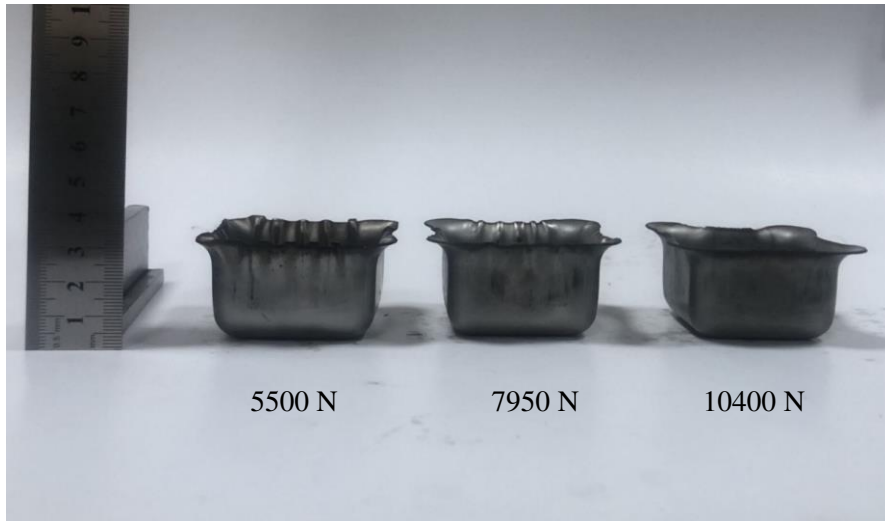
Şekil 5.60. 5^\circ ve 8 mm olduğu durumda elde edilen numuneler
