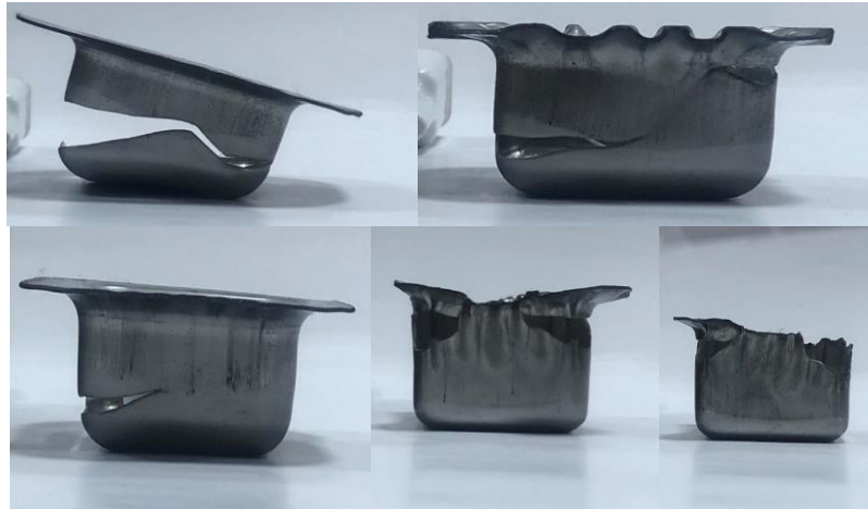
Şekil 5.75. Deneysel çalışmalar sonucunda oluşan çeşitli deformasyonlar ve hatalar
