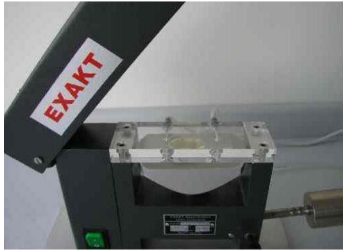
Şekil 3.7: Pleksiglas yapıştırma Ünitesi
