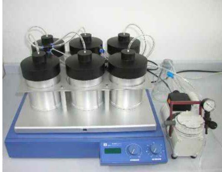
Şekil 3.5: Dehidratasyon ve infiltrasyon ünitesi
