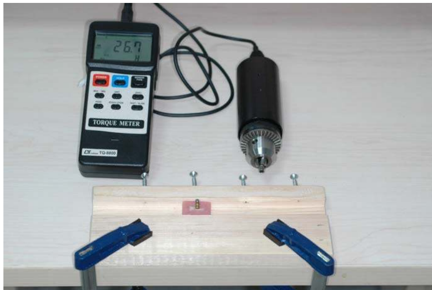
Şekil 3.11: Lutron TQ-8800 dijital torkmetre cihazı ve test düzeneği
