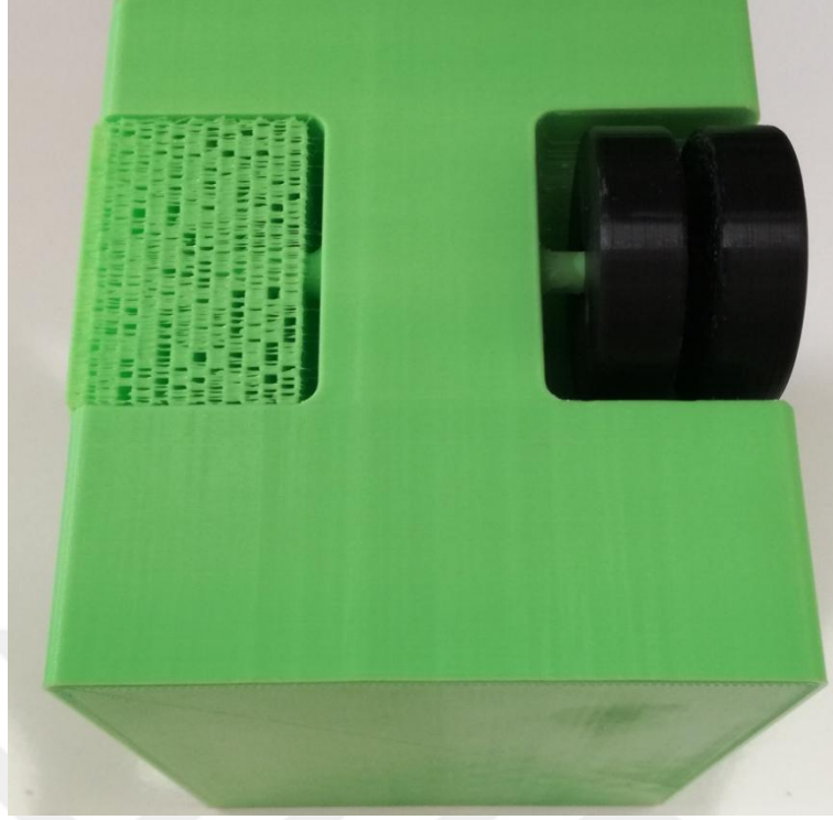
Resim 2.6. Üç-boyutlu yazıcıda basılan bir parçanın destek elemanlı (solda) ve destek elemanı çıkarılmış durumları. Destek elemanı çıkarılan kısma arka tekerlek takılmıştır
