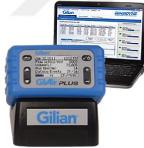
Şekil 4.2. Gilian GilAir Plus marka metal tozu ölçüm cihazı.
