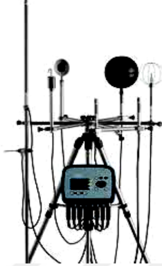
Şekil 4.5. Delta OHM HD32.1 marka termal konfor ölçüm cihazı.
