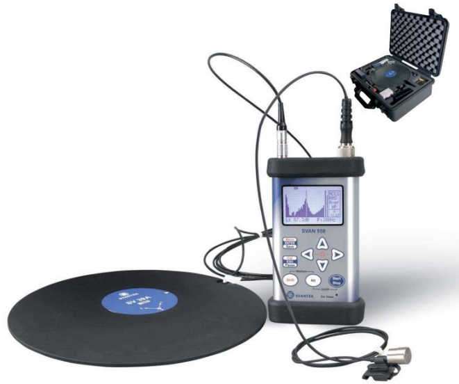
Şekil 4.6. SVAN 958 marka titreşim maruziyet ölçüm cihazı.
