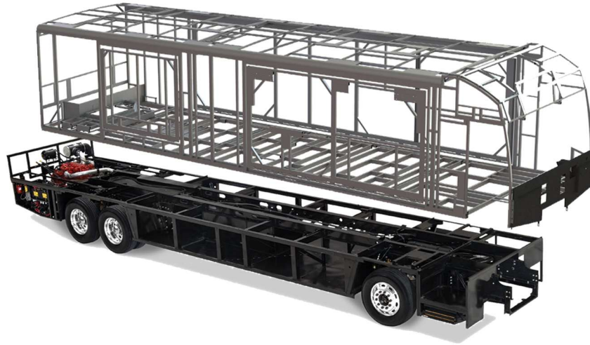
Şekil.2.4 Endüstriyel montaj: Otobüs şasisi ve kabin çerçevesinin birleştirilmiş uygulama fotoğrafı.
