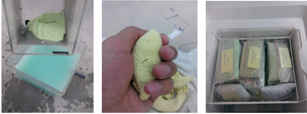
Şekil 3.17 Kesafet artırma ve soğutucuda saklama işlemi
