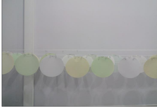
Şekil 3.24 Test kağıtlarının şartlandırılması
