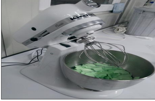
Şekil 3.13 Hobart tipi pulper ve hamurlaştırma işlemi
