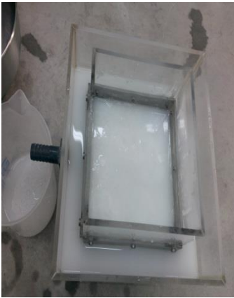
Şekil 3.14 Hamurlaştırma işlemi sonrası yapılan yıkama işlemi
