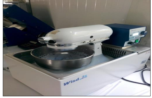
Şekil 3.13 Hobart tipi pulper ve hamurlaştırma işlemi
