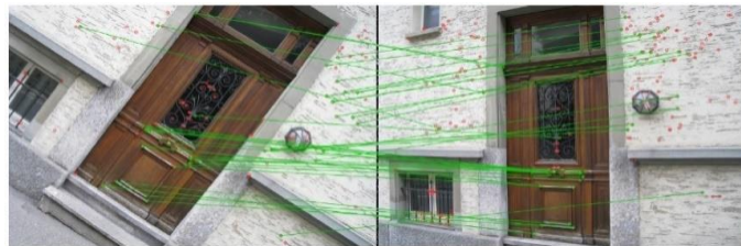
Şekil 3.37. BRIEF ile anahtar nokta tanımlayıcıları oluşturma [61].
