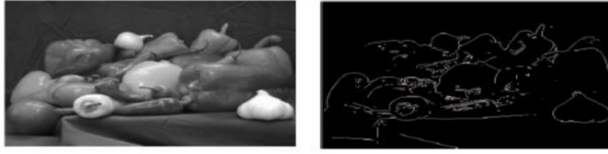
Şekil 3.23. Sobel filtresi sonuçları [7].
