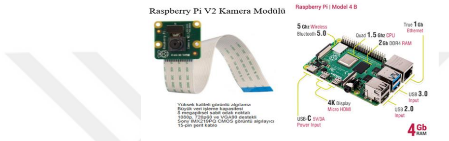
Şekil 4.1. Raspberry Pi 4B modeli ve V2 kamera modülü özellikleri.
