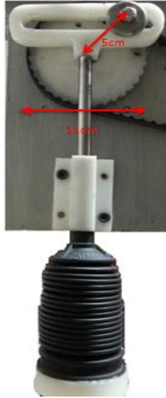
Şekil 2.17. Kompresyon için Scotch-Yoke mekanizması
