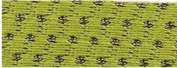
Şekil 3.5. Çözgülü örme düz kumaş
