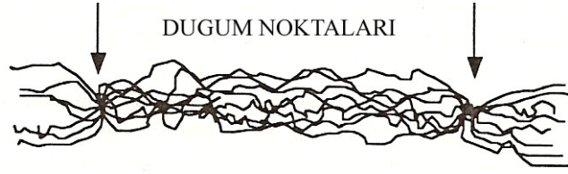
Şekil 2.7. Yalancı büküm tekstüre yapılmış ipliğin relakse olmuş hali
