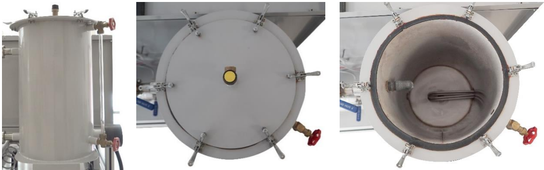
Şekil 3.20. Depo ve rezistansı çeşitli açılardan gösteren fotoğraflar
