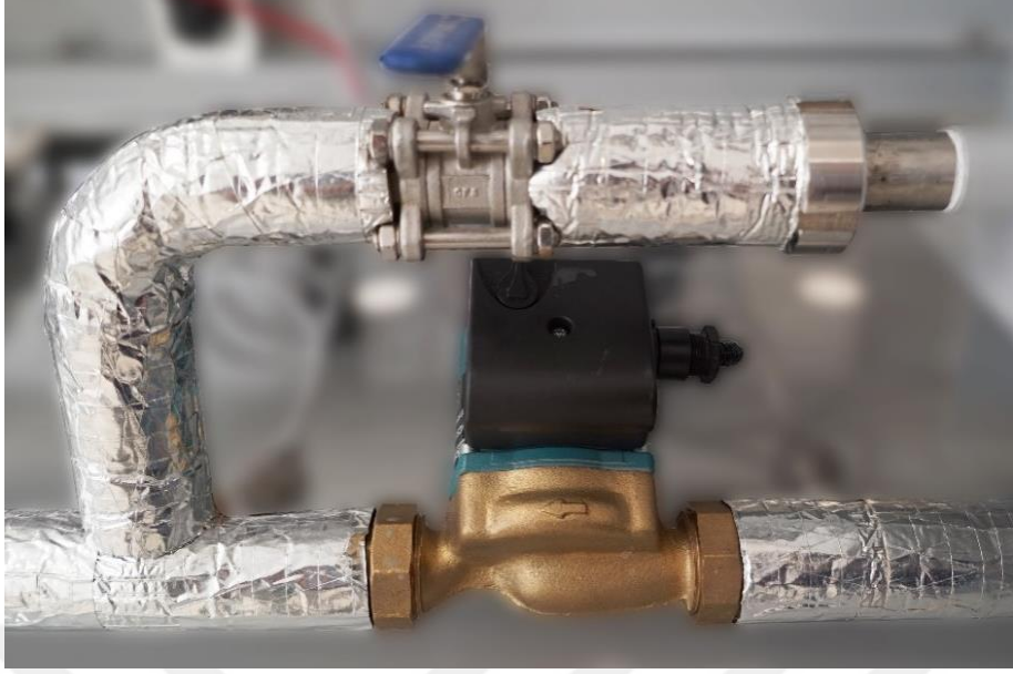
Şekil 3.21. Pompanın by-pass hattı ile beraber bağlantı şekli
