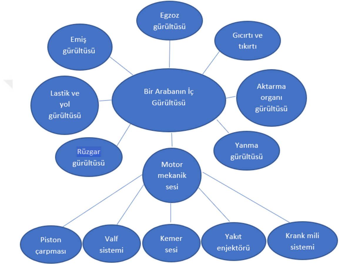
Şekil 2.3. Bir aracın iç gürültüsünün gürültü kaynakları
