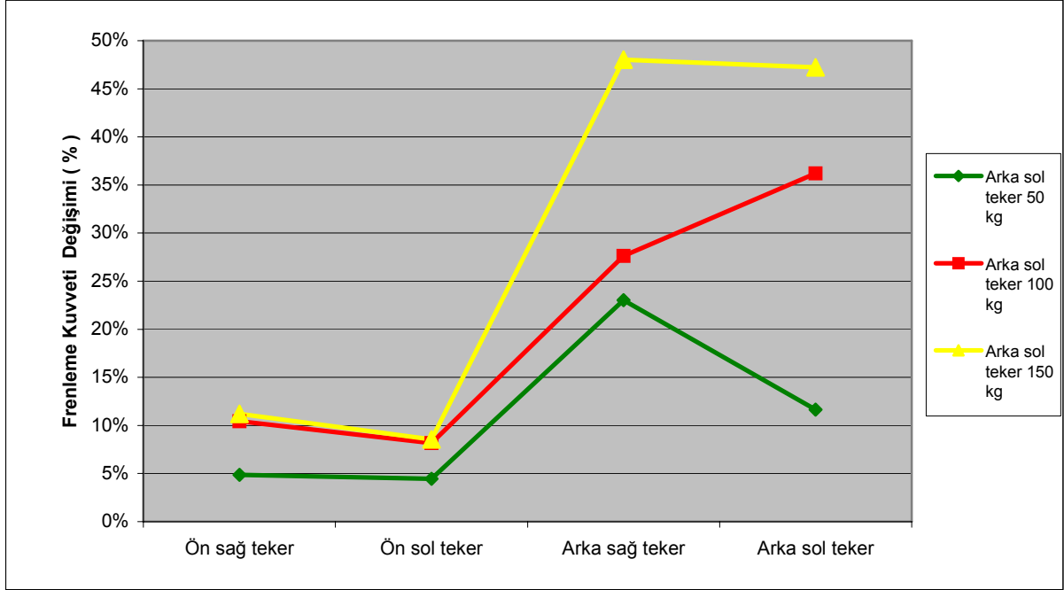
Şekil 5.24 Örnek 2 marka otomobilin sol arka tekerleğine uygulanan 50, 100 ve 150 kg lık yükler sonucu frenleme kuvvetinin, aracın boş durumundaki frenleme kuvvetine göre % değişimi.
