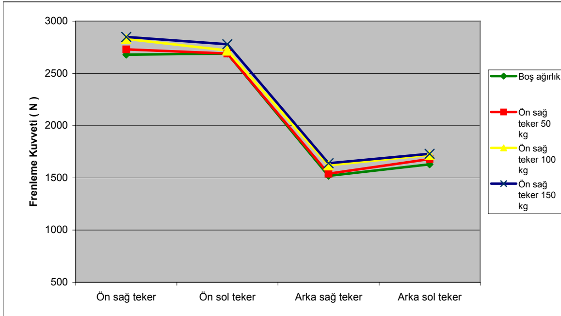
Şekil 5.19 Örnek 2 marka otomobilin sağ ön tekerleğine uygulanan 50, 100 ve 150 kg lık yükler sonucu tüm tekerleklerdeki frenleme kuvvetleri ve değişimleri.
