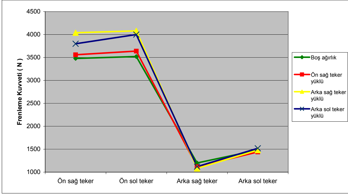
Şekil 5.5 Örnek 1 marka otomobil ile 100 kg yüklenecek yapılan fren testi.
