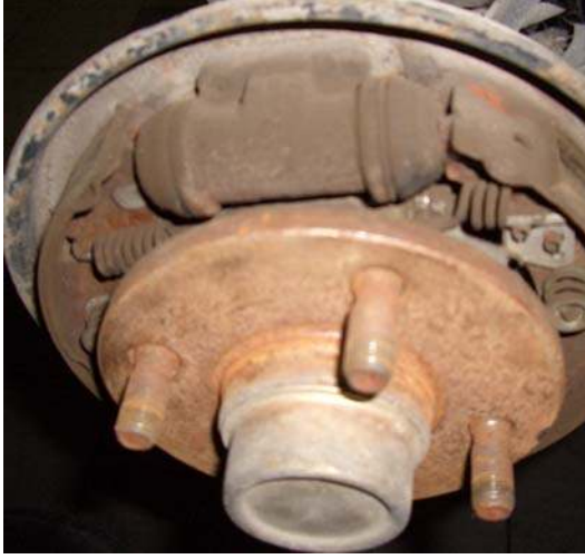
Şekil 2.4 Nissan Micra araca ait fren kampanası görünüşü.
