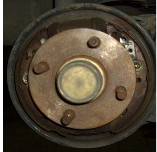
Şekil 2.4 Nissan Micra araca ait fren kampanası görünüşü.
