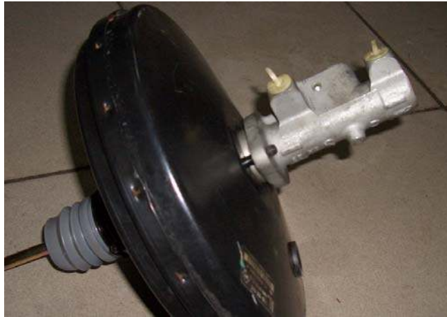
Şekil 3.21 Nissan Micra aracın fren servosu
