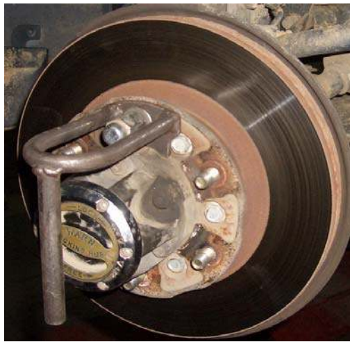
Şekil 2.1 Nissan Pathfinder araca ait fren diski görünüşü.
