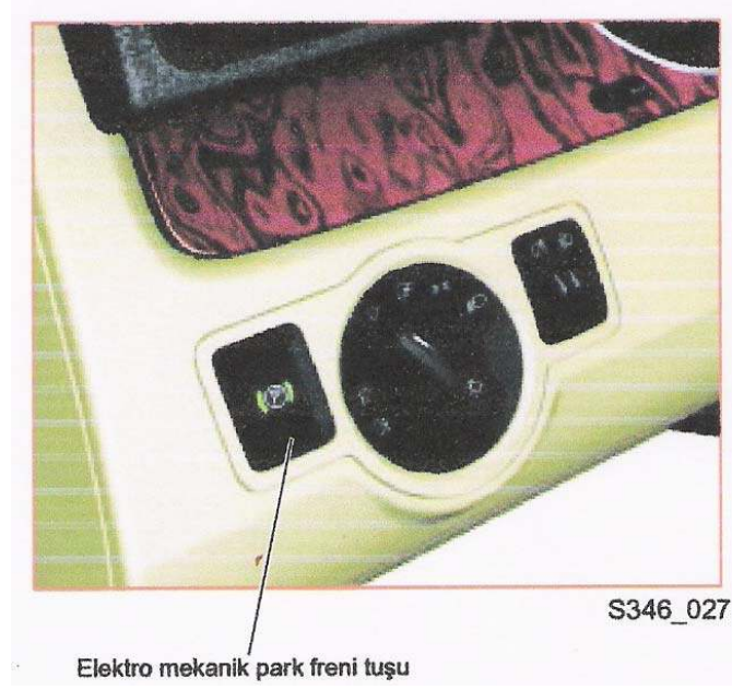
Şekil 6.8 Elektro mekanik park freni tuşu. ( VW eğitim notları )
