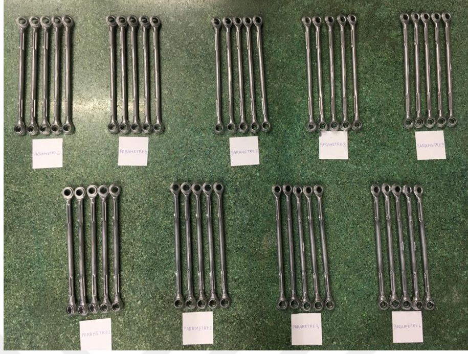
Şekil 3.15 9 Farklı deney parametresi için üretilen deney çubukları
