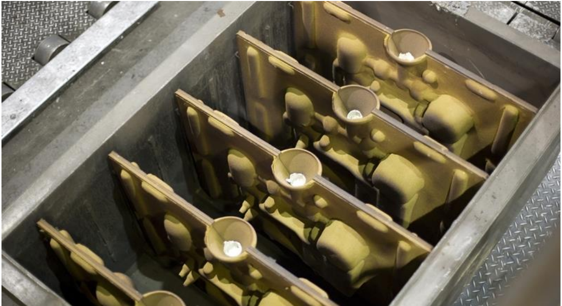
Şekil 2.3. Dökümden önceki aşamada hazırlanmış olan kabuk kalıplar
