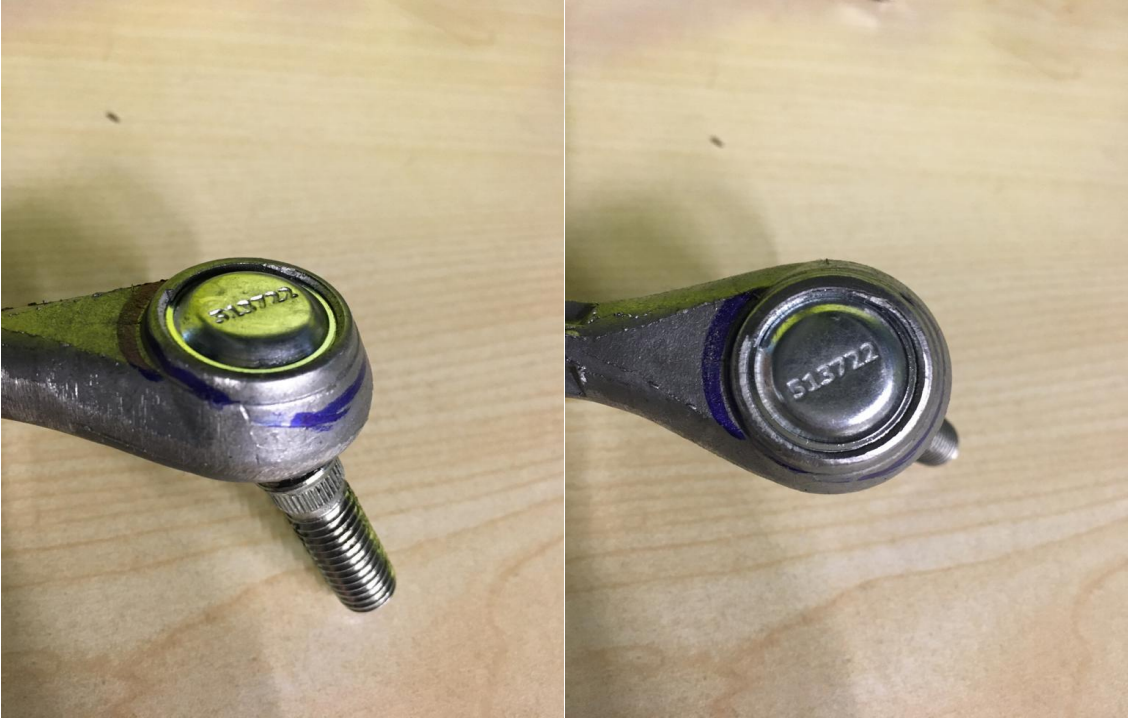
Şekil 4.12 Sıvama sırasında hasar meydana gelmiş parça
