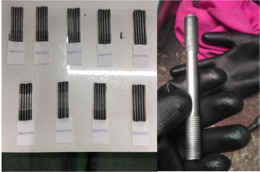
Şekil 3.19. Hazır hale gelmiş çekme çubuğu ve gruplandırılmış numuneler
