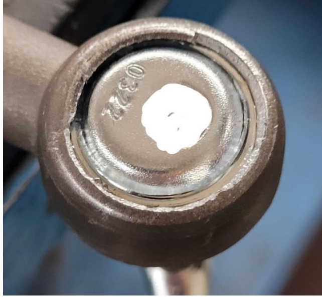
Şekil 3.29. Kapak kapama işlemi yapılmış kesitte meydana gelen hasar
