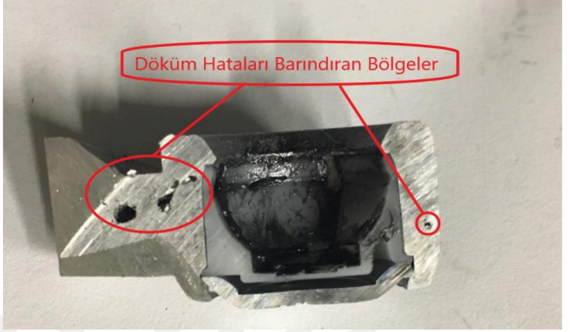
Şekil 4.13 Porozite hataları barındıran kırılma gerçekleşmiş parça
