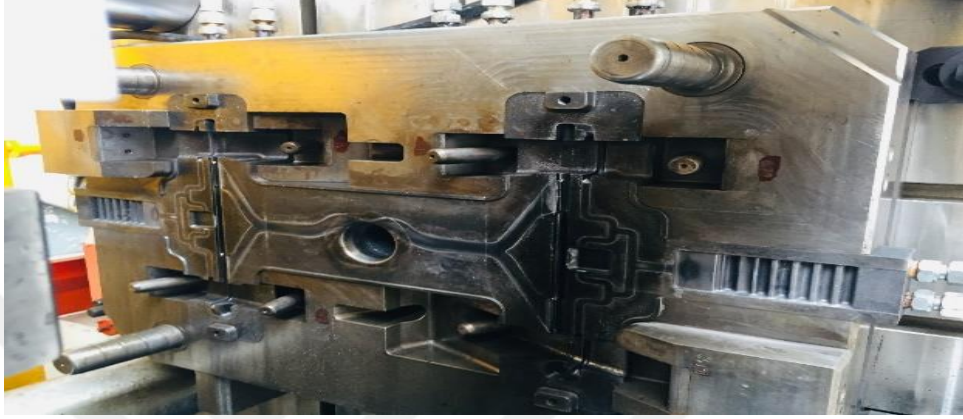
Şekil 3.9 Yüksek basınçlı döküm makinasına bağlanmış imal edilmiş kalıp
