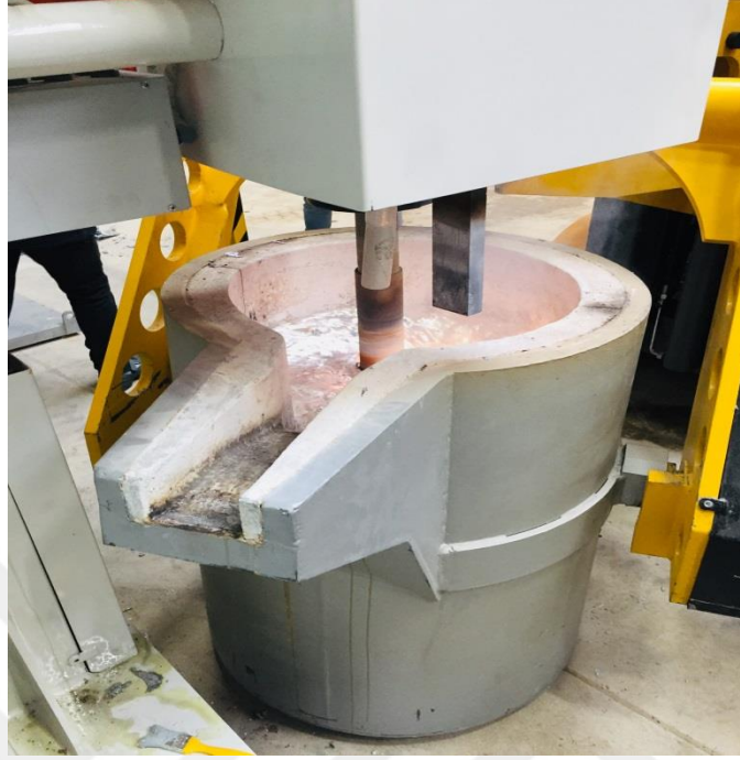
Şekil 3.12 Azot gazı kullanılarak gerçekleştirilen gaz alma işlemi
