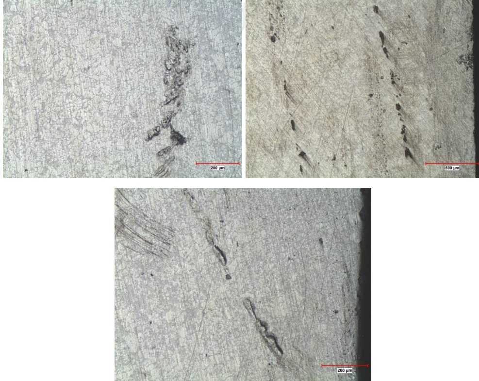
Şekil 4.18 8.deneye ait numunelerde plastik değişim bölgesi kesitinde görüntülenenen mikroporoziteler
