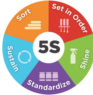
Şekil 1.3: TPM metotlarından biri olan 5S uygulamasının diyagramı
