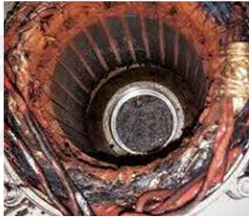
Şekil 4.14. Stator arızası yaşamış bir motor bobini
