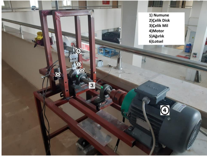
Resim 4.1 Prototip aşınma test cihazı.
