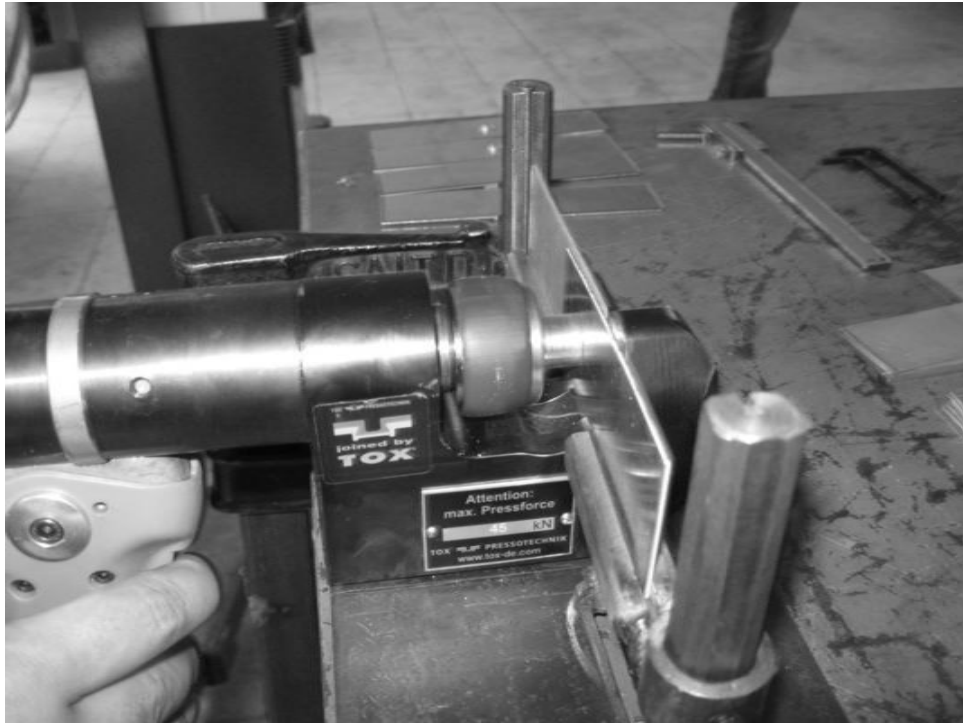
Şekil 3.7 Sac malzemelerin clinching sistemi ile birleştirilmesi
