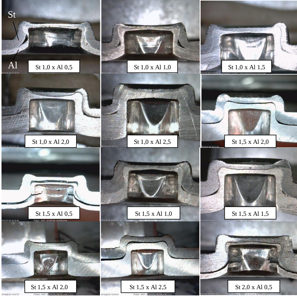
Şekil 4.24 ST1314 saç malzeme ile AL5754 alüminyum malzemelerin birleşme kesiti
