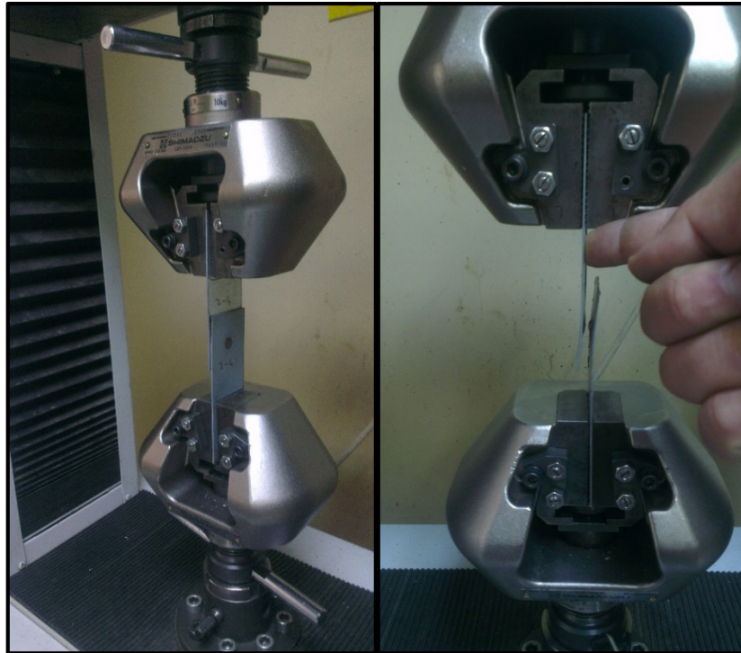
Şekil 5.3. 6 kA ve 15p'de TRIP800 ve DP600'ün çekme makaslama testi
