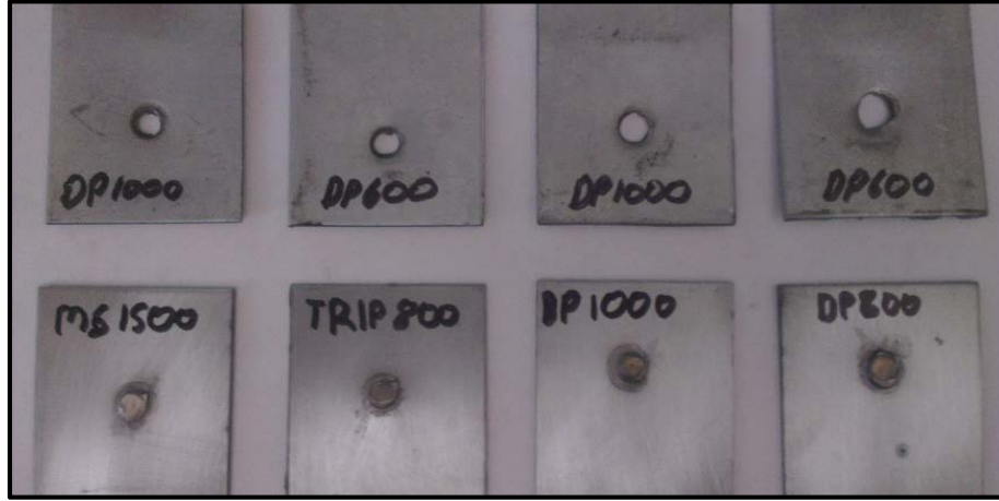
Şekil 5.4. 10 kA ve 25p'da ki kaynakların çekme makaslama testi sonrası
