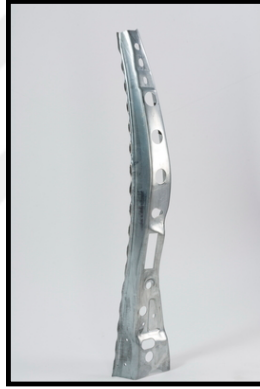
Şekil 3.11. DP çeliğinden üretilmiş B direği [13].
