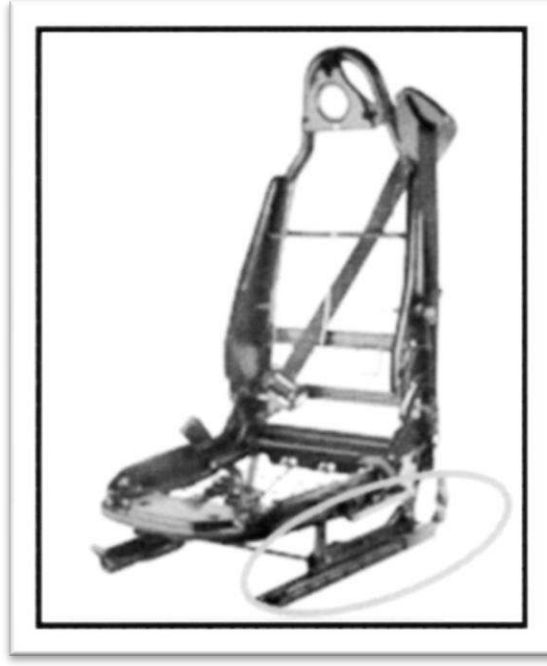
Şekil 6.3 Araç koltuk gövde yapısı
