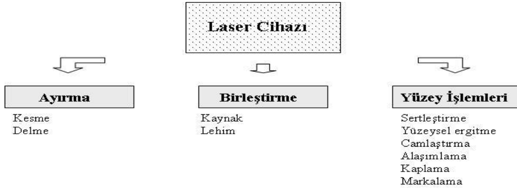
Şekil 3.1 Laser sistemleri ile gerçekleştirilen çalışma alanları[1]
