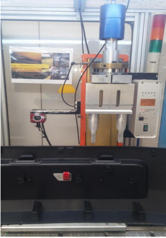
Resim 4.11. Ultrasonik kaynak teknolojisi
