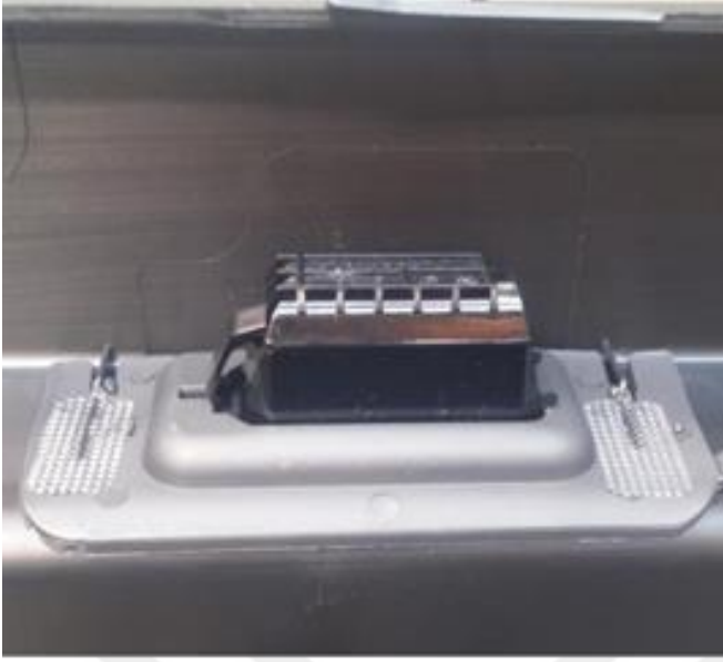
Resim 4.13. Ultrasonik kaynak görüntüsü
