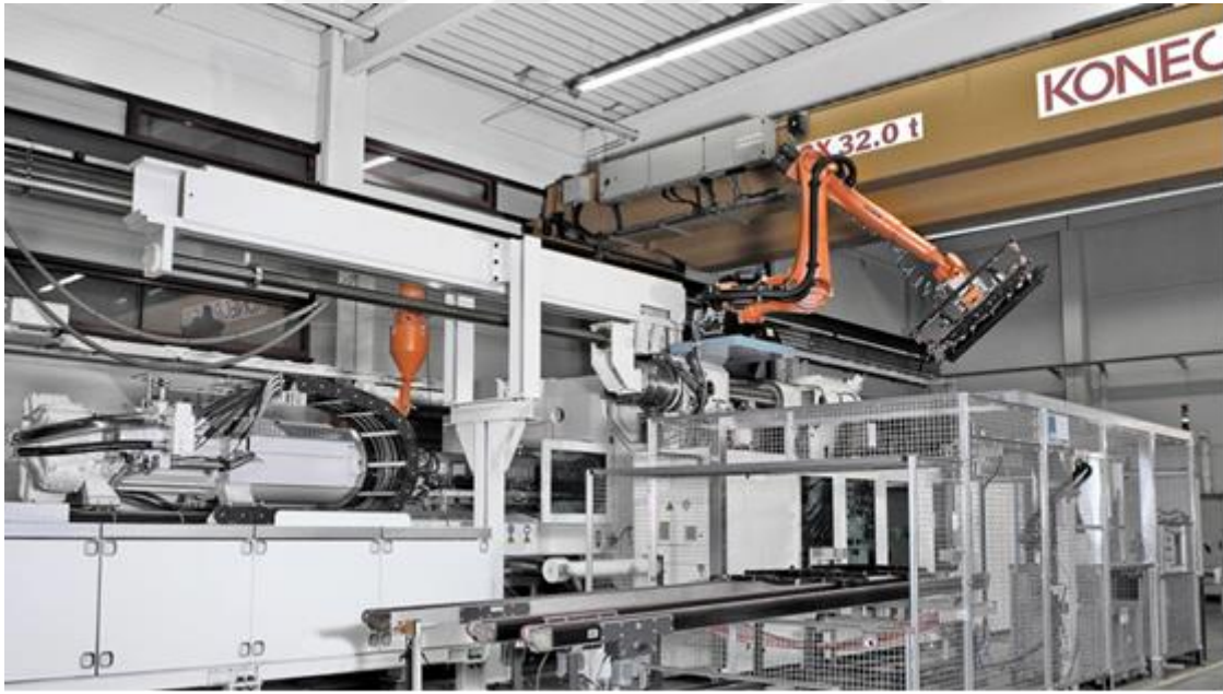
Resim 2.5. Plastik enjeksiyon makinasına entegre edilmiş robot
