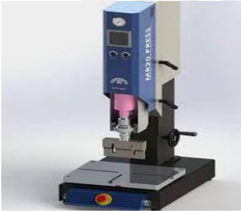
Resim 4.2. Ultrasonik kaynak ile birleştirme
