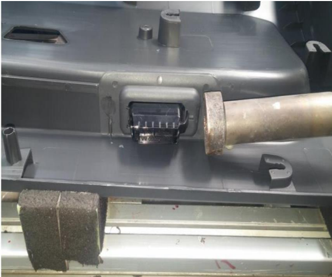
Resim 4.12. Isıtıcı uç ile el ile kaynak.
