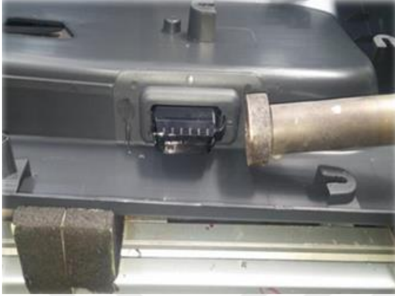
Resim 4.1. Isıtıcı uç ile birleştirme
