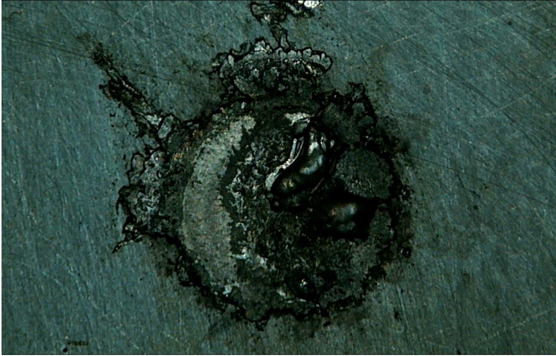
Şekil 4.6 Çekme deneyi sonunda ayrılan Mg numunenin ara yüzey görüntüsü.
