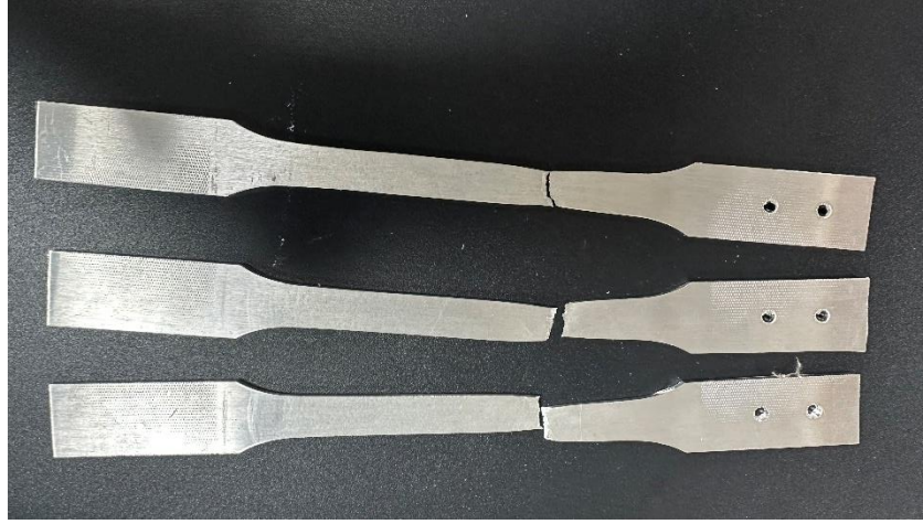
Resim 4.3 Çekme deneyi sonrası AZ31B magnezyum alaşım numunesine ait görsel.
