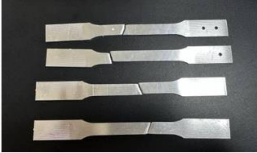
Resim 4.2 Çekme deneyi sonrası AA 1050 alüminyum alaşım numunesine ait görsel.
