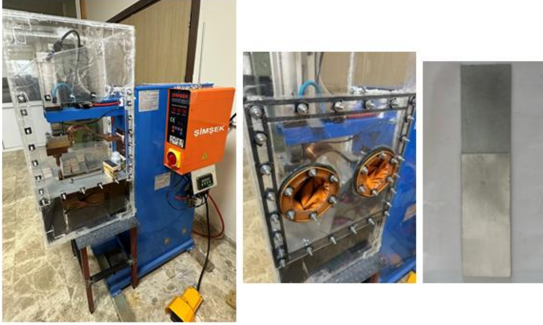
Resim 3.3 Kabin montajı yapılan nokta direnç kaynak makinesi ve birleştirilen numune.
