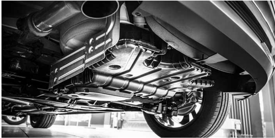
Resim 2.5 Otomobil alt kısmında galvanizli çelik kullanımı (İnt.Kyn.4).
