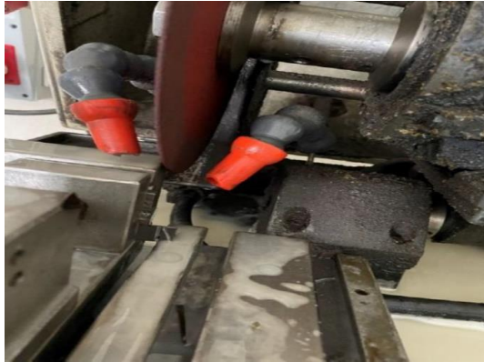
Resim 3.7 Metkon Metacut 250 manuel kesme cihazı görselleri.
