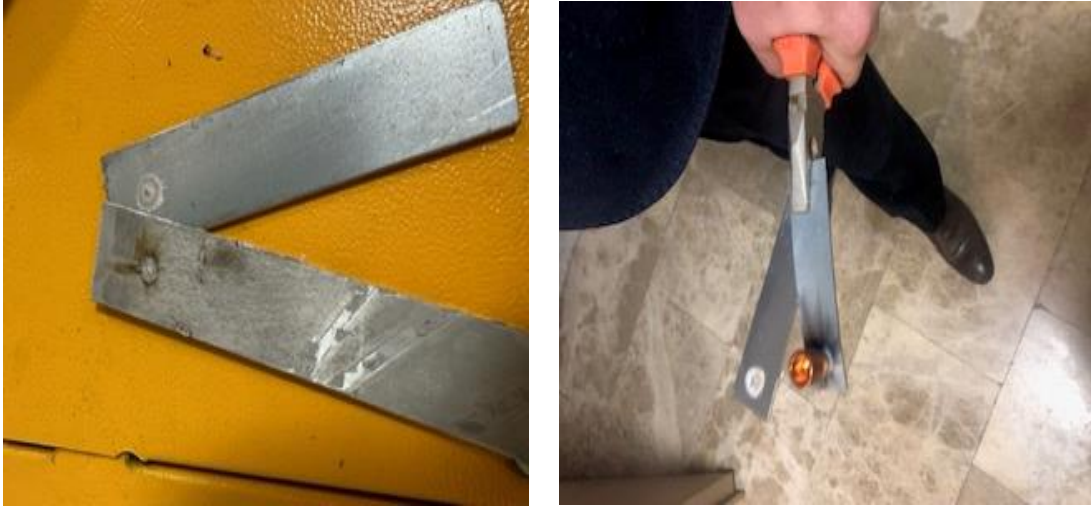
Resim 3.2 Normal oda koşullarında yapılan punta kaynak kusurları.
