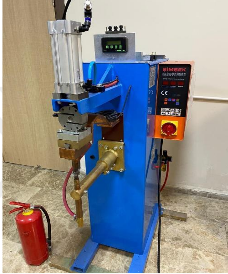
Resim 3.1 AKÜ Teknoloji Fakültesi Laboratuvarında bulunan nokta direnç kaynak makinesi.
