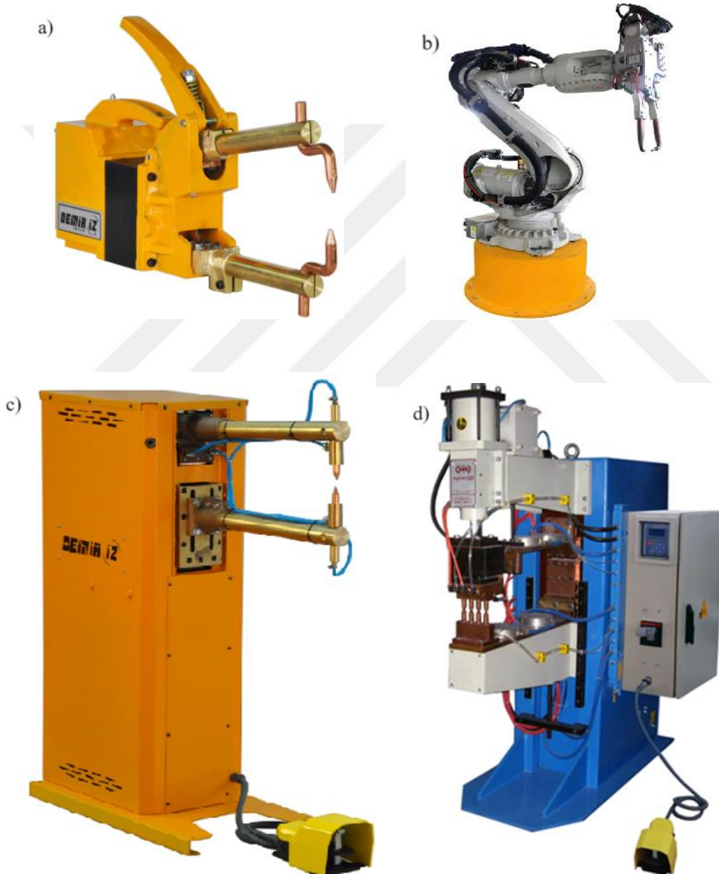
Resim 2.7 Punta direnç kaynak makine çeşitleri a) Seyyar tip (İnt.Kyn.5) b) Robot kollu (İnt.Kyn.6) c) Pres tipi (İn.Kyn.5) d) Çoklu kaynak (İnt.Kyn.7).
