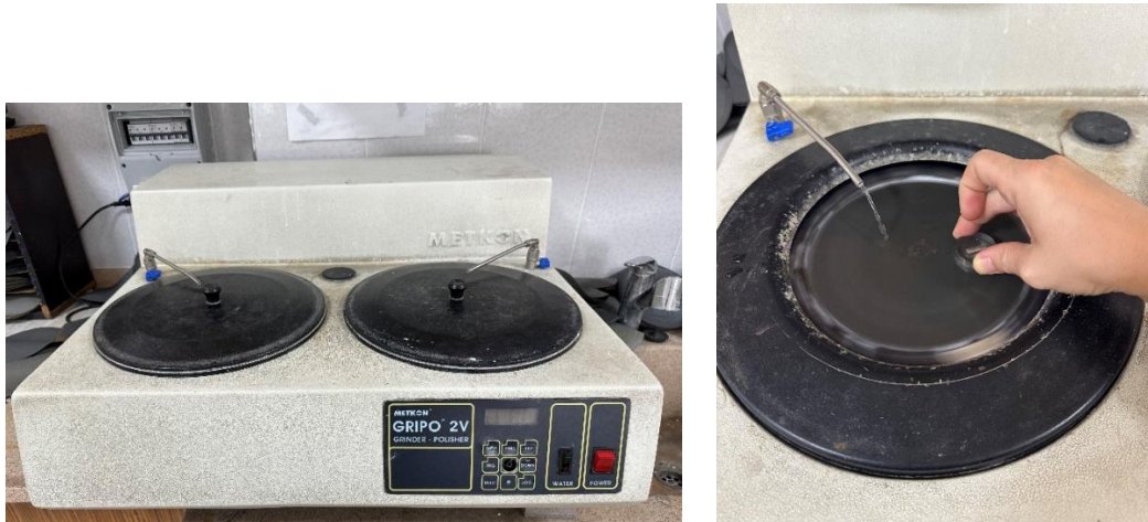
Resim 3.9 Metkon Gripo 2V marka zımparalama ve parlatma cihazı.
