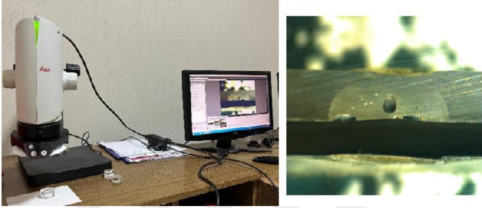
Resim 3.10 Lecia DMS 300 Mikroskop görseli ve kaynak bölgesinin mikroskop altındaki görüntüsü.
