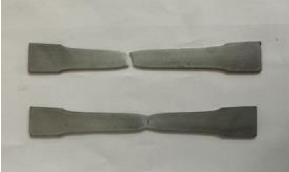
Resim 4.1 Çekme deneyi sonrası Erdemir 1314 Galvanize çelik numunesine ait görsel.
