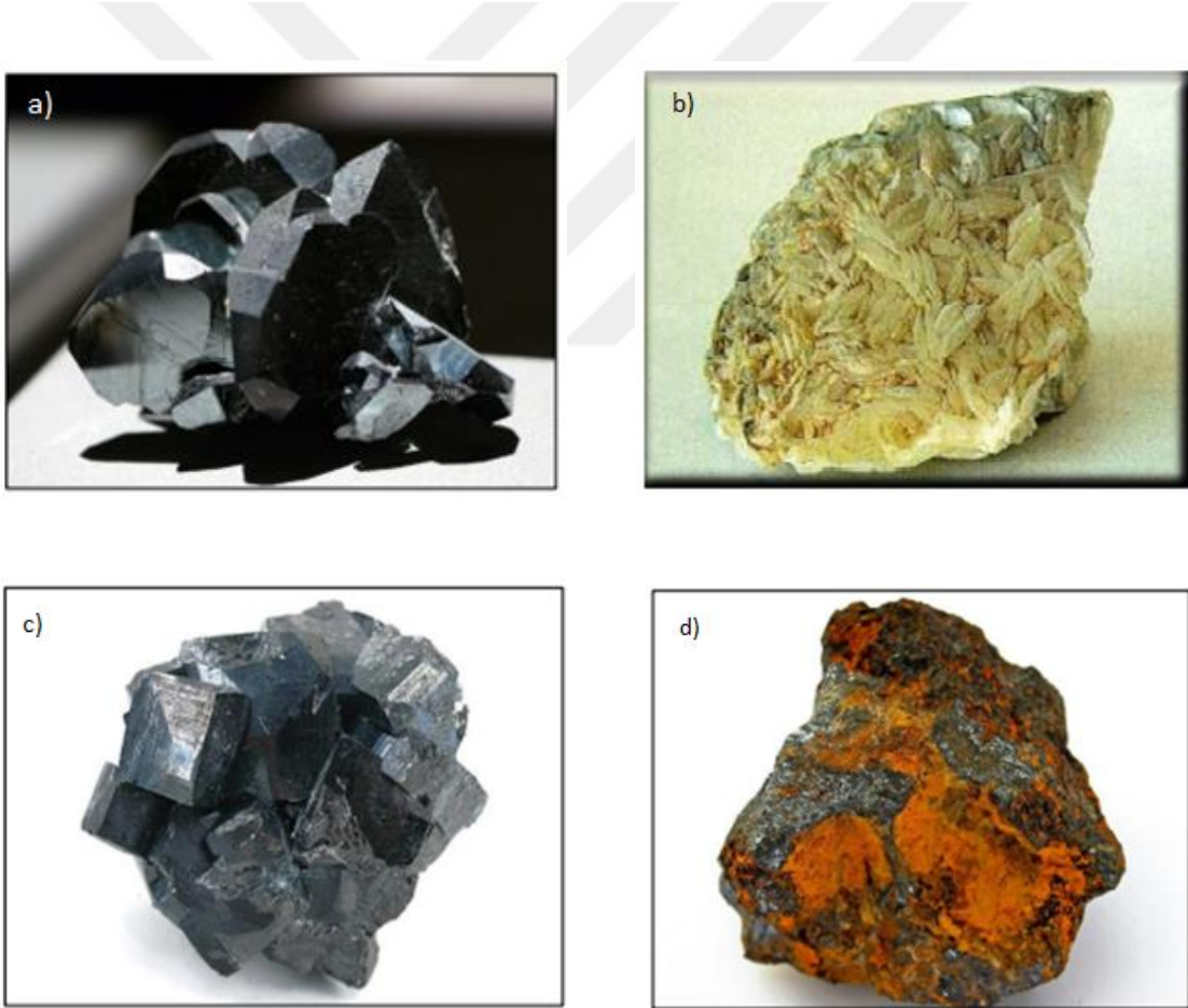
Resim 2.3 Demir bileşikleri a) Hematit b) Siderit c) Manyetit d) Limonit (Dinlen 2022).
