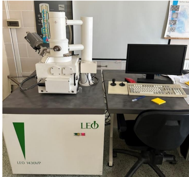
Resim 3.11 LEO 1430 VP model taramalı elektron mikroskobu (SEM).
