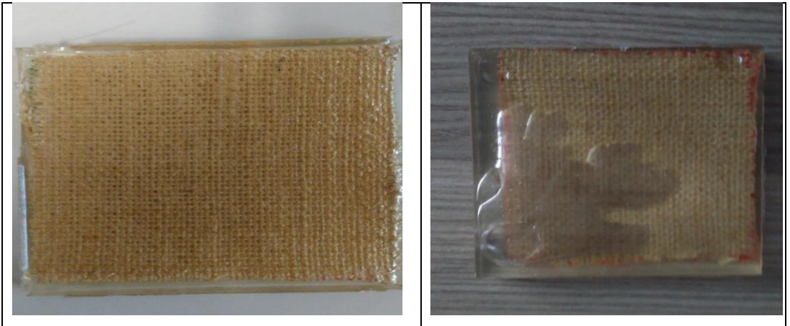
Şekil 3.5 : Ön test deneyi sonucu üretilen PLA/Jüt kompozitinin üst ve alt görüntüleri.
