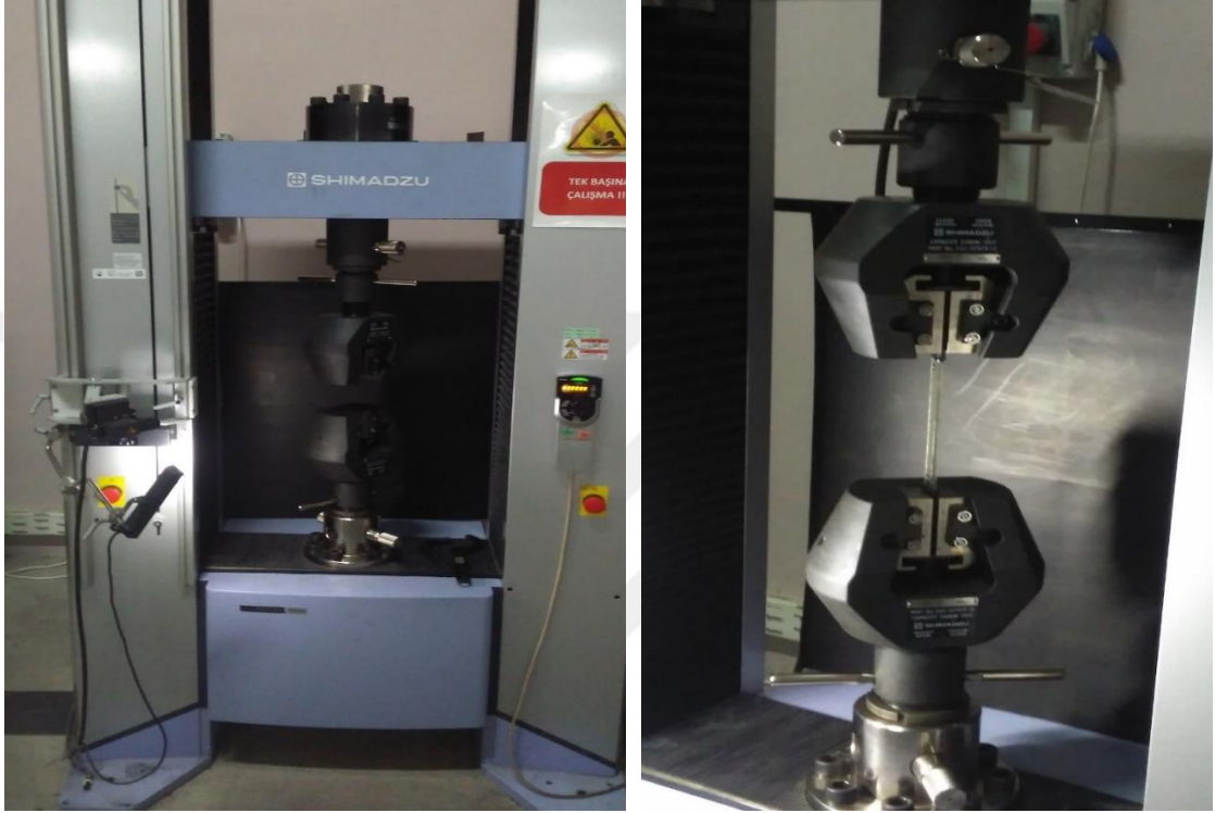
Şekil 3.13 : Çekme Deneyinde kullanılan universal çekme cihazı ve tutucu çeneler. Her bir numune için gerçekleştirilen çekme testi spesifikasyonları aşağıda verilmiştir.
