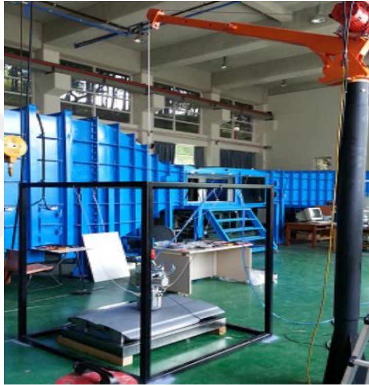
Şekil 2.4 Darbe testi düzeneği (Kim ve Kang 2014)
