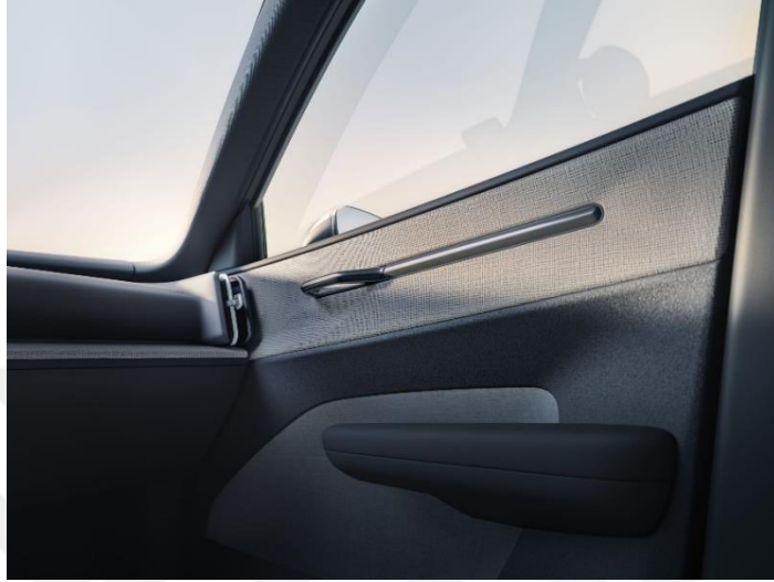
Şekil 2.14 Volvo EX30 keten kompozit iç kapı trimi (İnt. Kyn. 9)
