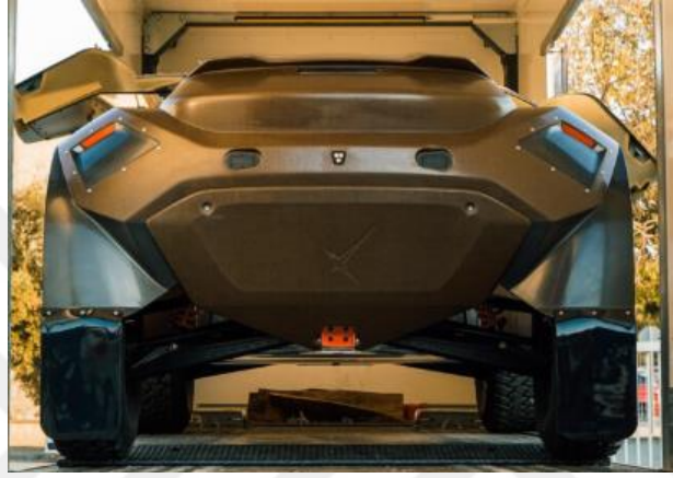
Şekil 2.11 Keten kompozit gövdeli Spark Odyssey All-Electric SUV (İnt. Kyn. 8)
