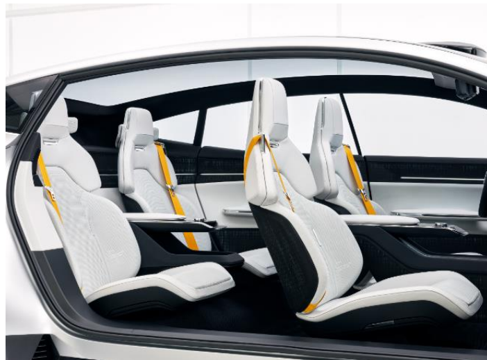
Şekil 2.13 Polestar Precept biyo kompozit iç trimleri (İnt. Kyn. 9)
