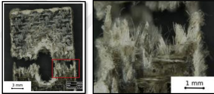
Şekil 2.7 Çekme testi Yapılmış geleneksel baęlantı yöntemi ile birleştirilen keten kompozit. (Fiorea vd. 2018)
