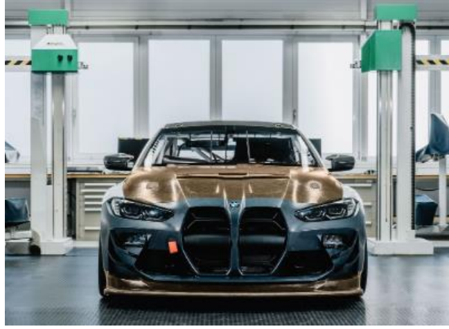
Şekil 2.9 Keten kompozit parçalara sahip BMW M4 GT4 (İnt. Kyn. 8)
