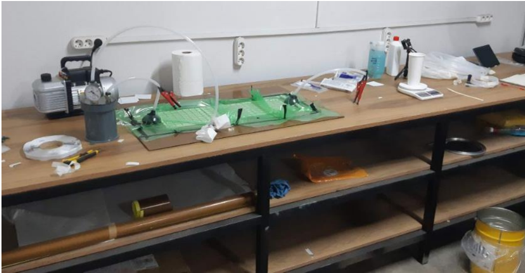
Şekil 3.10 Vakum infüzyon deney düzeneği
