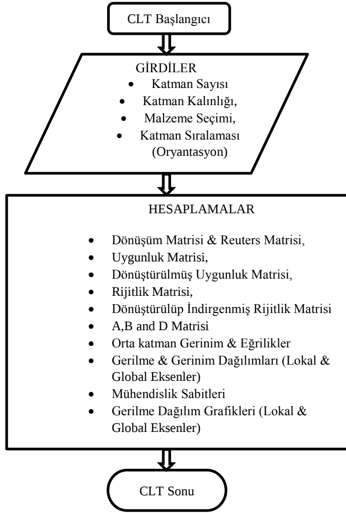
Şekil 4.1 : Kompozit Katman Teorisi Matlab Akış Diyagramı
