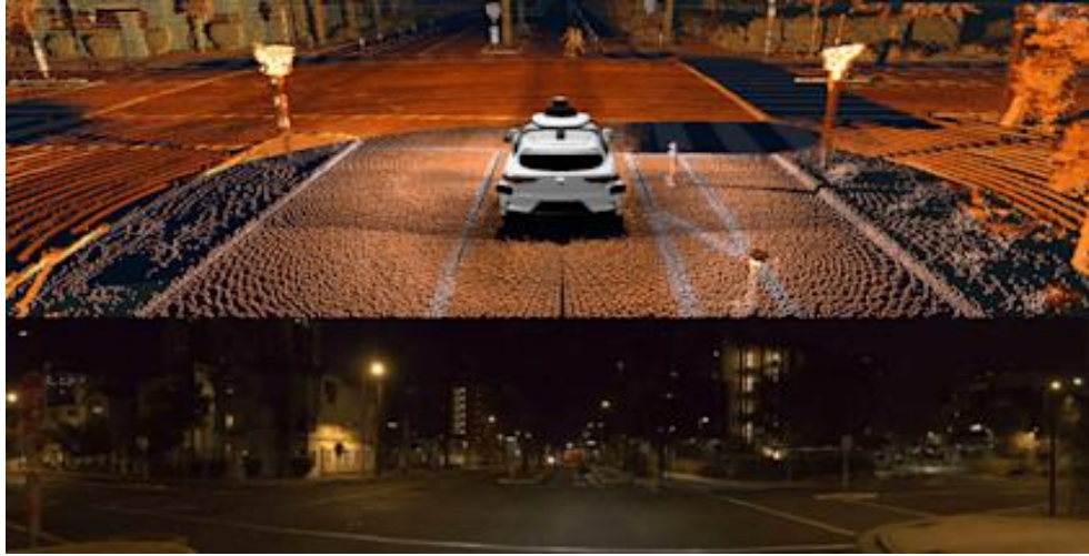
Şekil 2-4: LiDAR ile elde edilen nokta bulutunun görselleştirilmesi[103]
