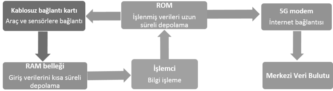
Şekil 5-5: Araç Kontrol Merkezi'nin çalışma döngüsü
