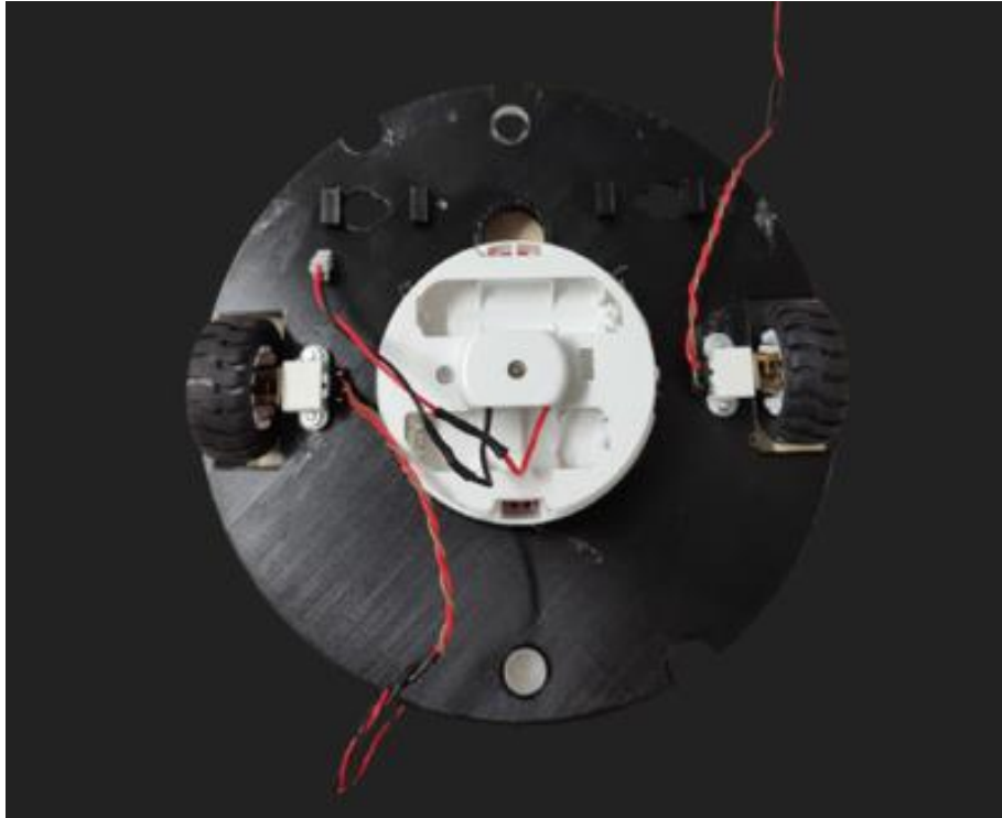
Şekil 4.1 Tekerlekler ve Vakum Aparatının Montajı
