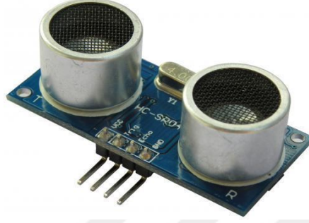
Şekil 3.6 HC-SR04 Ultrasonik Sensör
