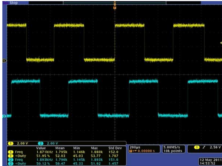
Şekil 2.6: Dördün kodlayıcının A ve B kanallarındaki sinyaller.
