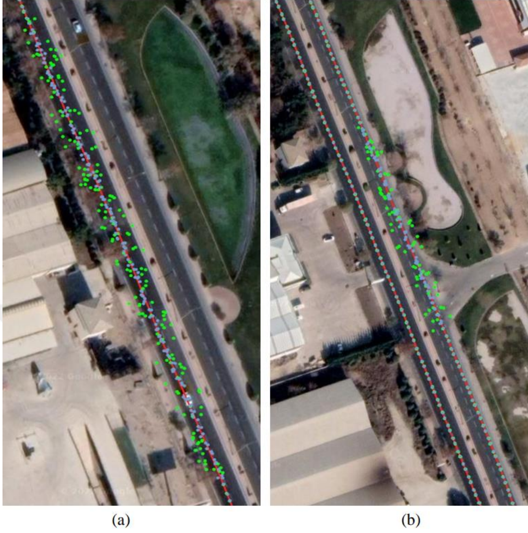
Şekil 5.11. Multi-step düzeltme filtresi şemasıyla ve şemasız UKF tabanlı yaklaşımlar kullanılarak, gürültülü RTK-GNSS verilerinde öngörülen yörüngeler ile referans arasındaki karşılaştırma.
