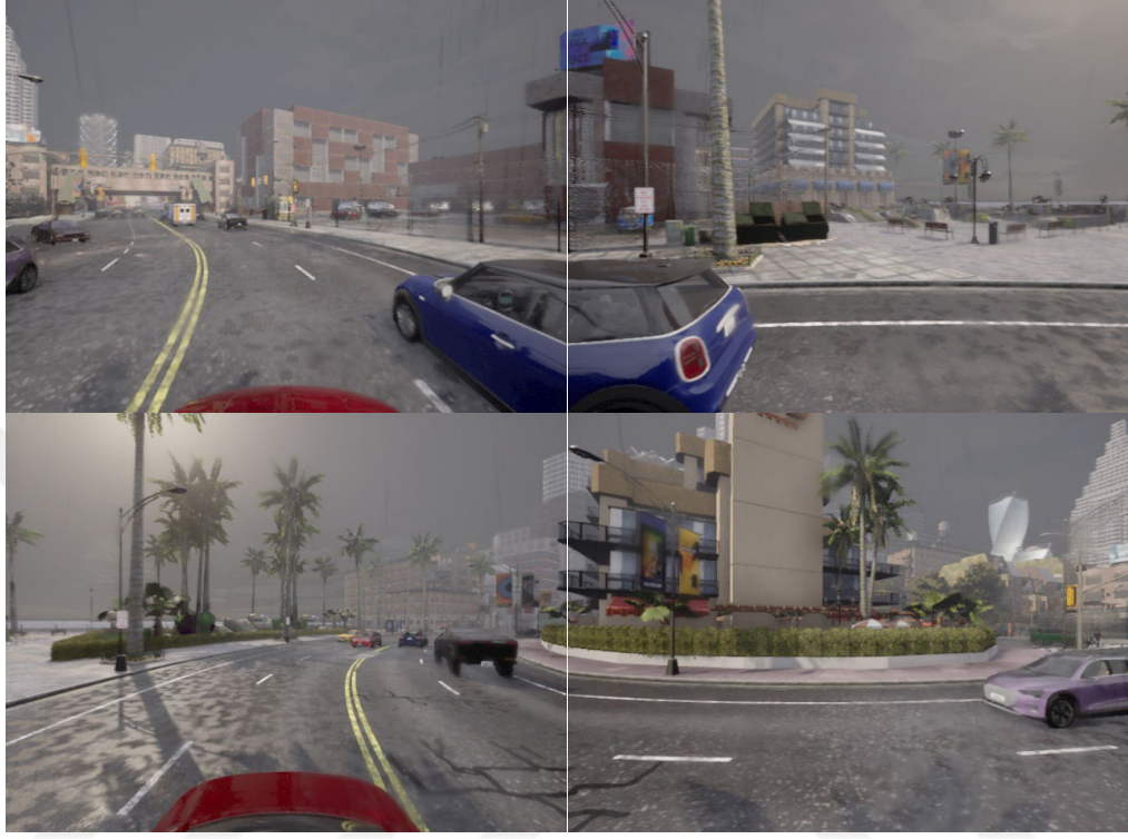
Şekil 6.1 Aracın dört yönünü gösteren RGB kameralar. Üst sıra, soldan sağa, ön ve sağ kamera; alt sıra soldan sağa, arka ve sol kamera
