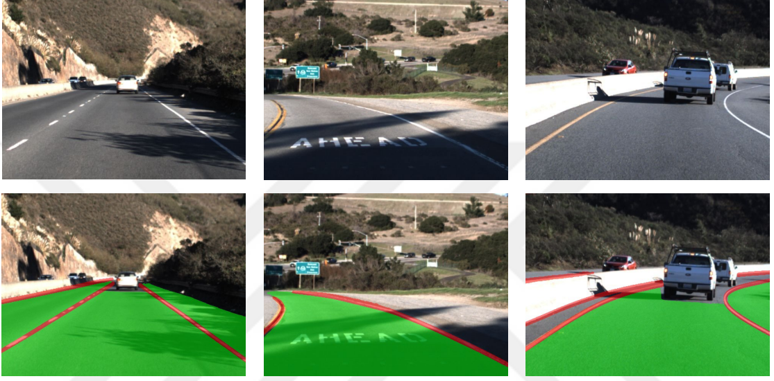
Şekil 3.3 Üst sırada Udacity veri kümesinden rastgele alınmış üç adet orijinal RGB görüntü ve alt sırada bu görüntülerin YOLOPv2 ile elde edilmiş anlamsal bölünmüş görüntüleri
