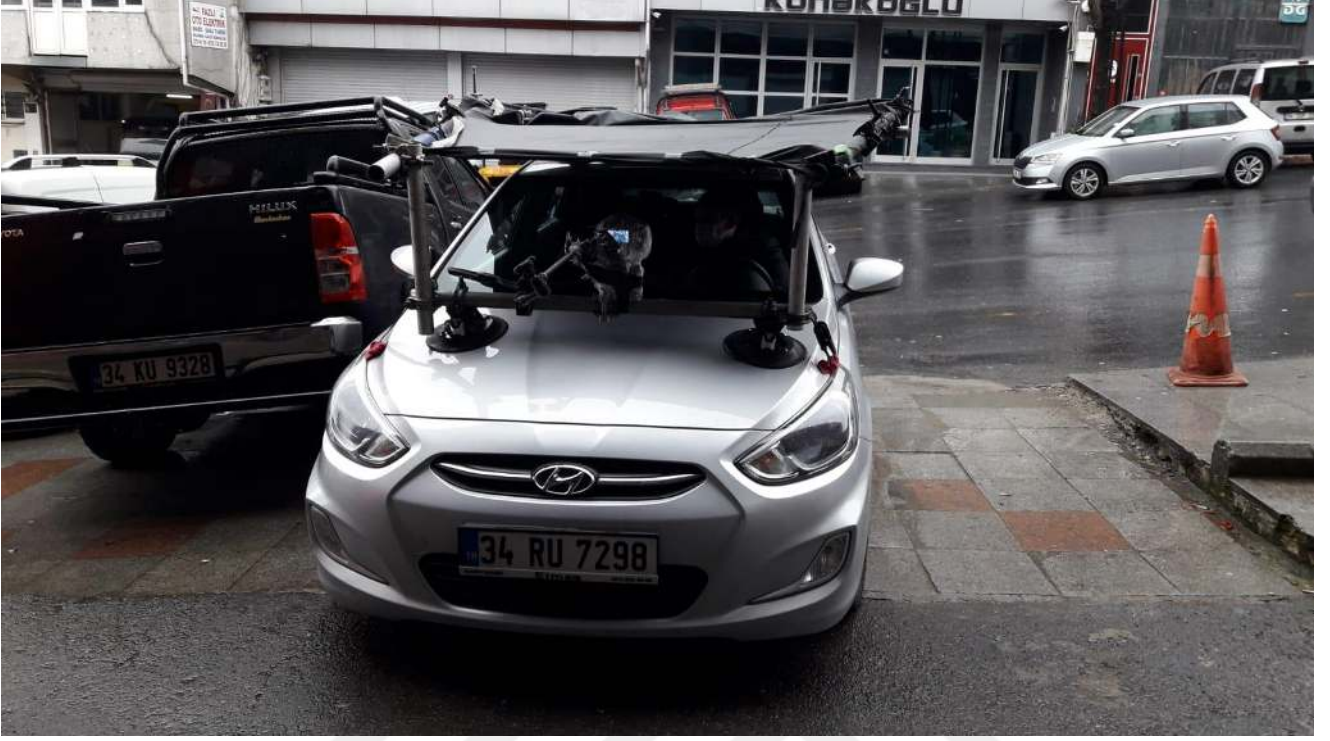
Resim 1 : Araba sahnelerinde yansıma önlemek için kurulan sistem.
