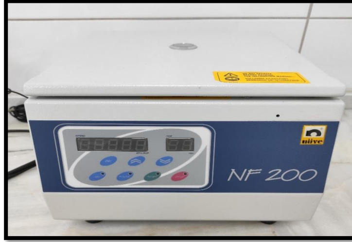
Resim 17. Kanların santrifüj edildiği NF 200 santrifüj cihazı
