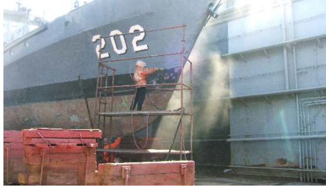
Şekil 6.10 Gemiye yapılan raspa uygulaması
