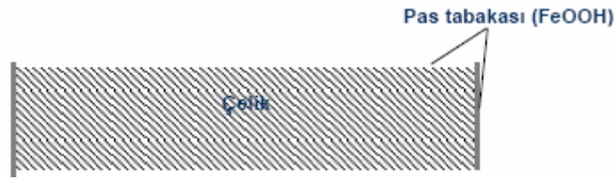
Şekil 2.2 Çelik yüzeyinde oluşan homojen korozyon [3]
