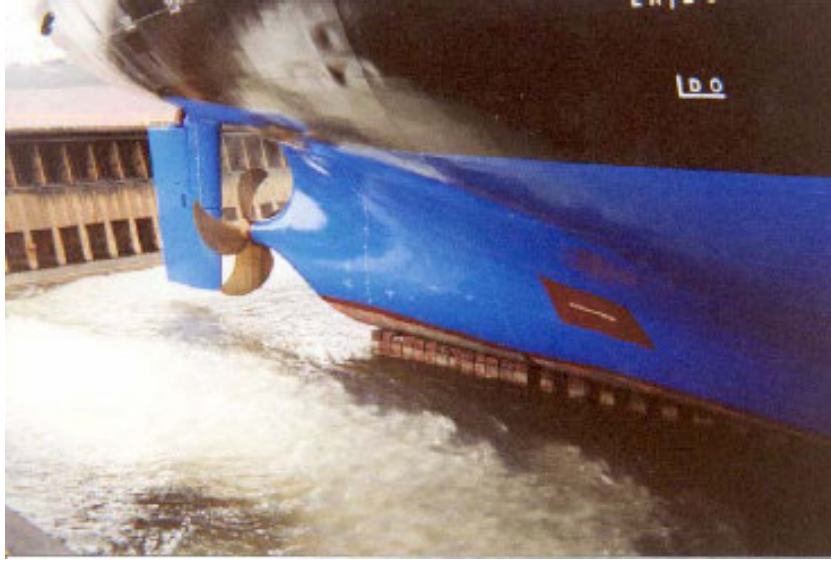
Şekil 4.5 Gemi gövdelerinin harici akım uygulama sistemi ile katodik olarak korunması [3]
