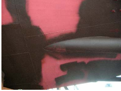
Şekil 6.17 Gemi stern tube bölgesinde, kaynak yerlerinin boyanması
