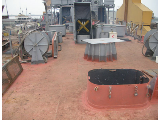
Şekil 6.30 Gemi güvertesinde astar boya uygulaması
