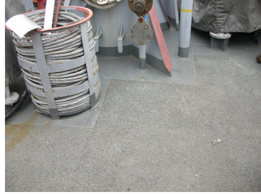
Şekil 6.31 Gemi güvertesinde kumlu boya uygulaması
