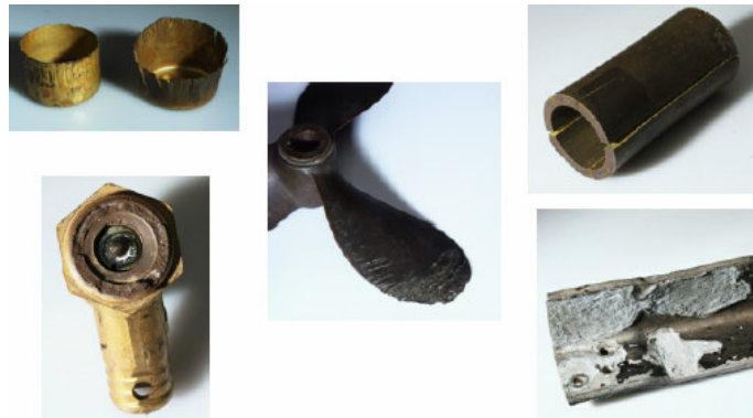
Şekil 2.9 Çeşitli parçalarda oluşan gerilmeli korozyon [3]
