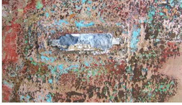
Şekil 6.5 Geminin karina bölgesine yerleştirilmiş tutya
