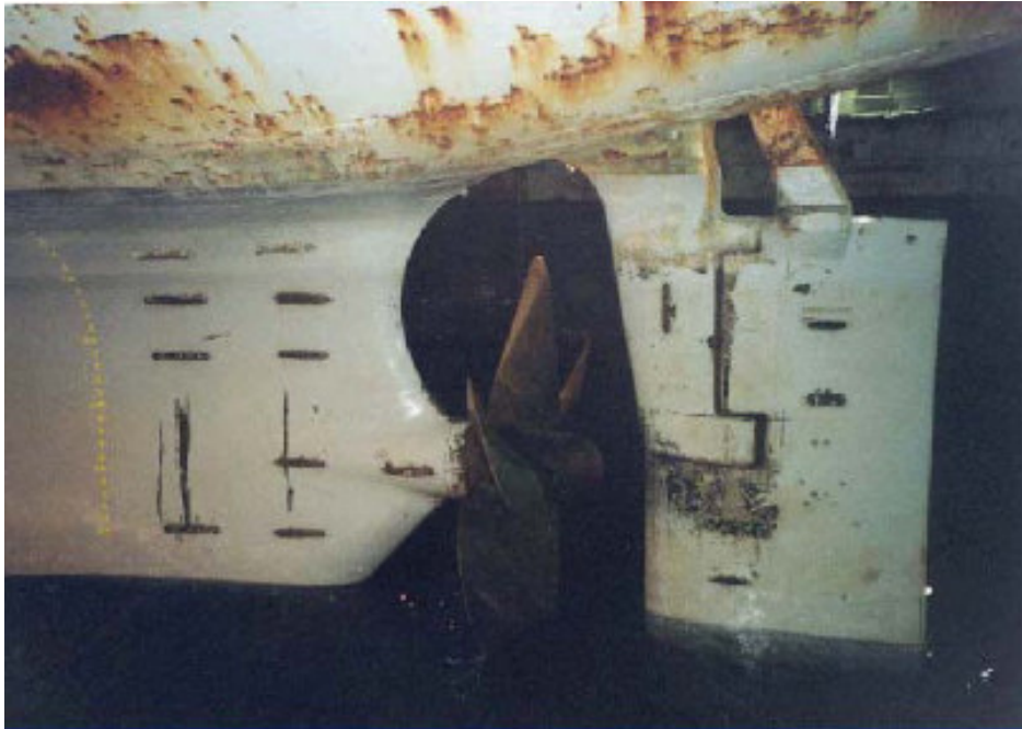
Şekil 4.4 Gemi gövdelerinin harcanabilir anotlarla katodik olarak korunması [3]
