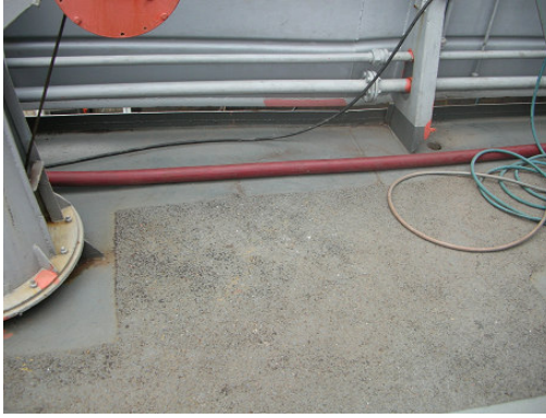
Şekil 6.31 Gemi güvertesinde kumlu boya uygulaması
