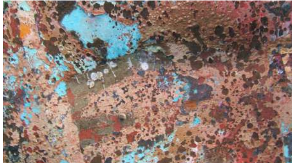
Şekil 6.7 Geminin karina bölgesinde korozyona uğrayan sac
