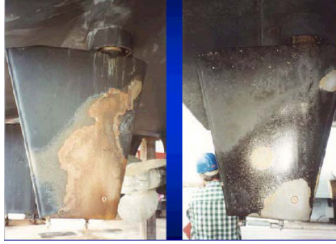
Şekil 2.13 Gemi uskurunda görülen kavitasyon korozyonu [3]
