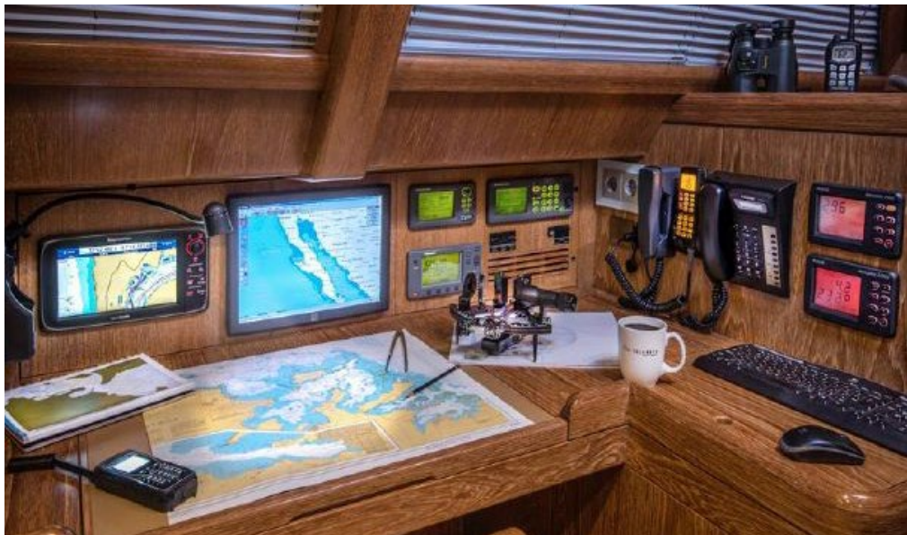
Görsel 4. 56. Harita masası, navigasyon cihazı, radar, telsiz, dürbün ve harita çiziminde kullanılan sekstant ve pergel içeren bir navigasyon istasyonu (http-126).
