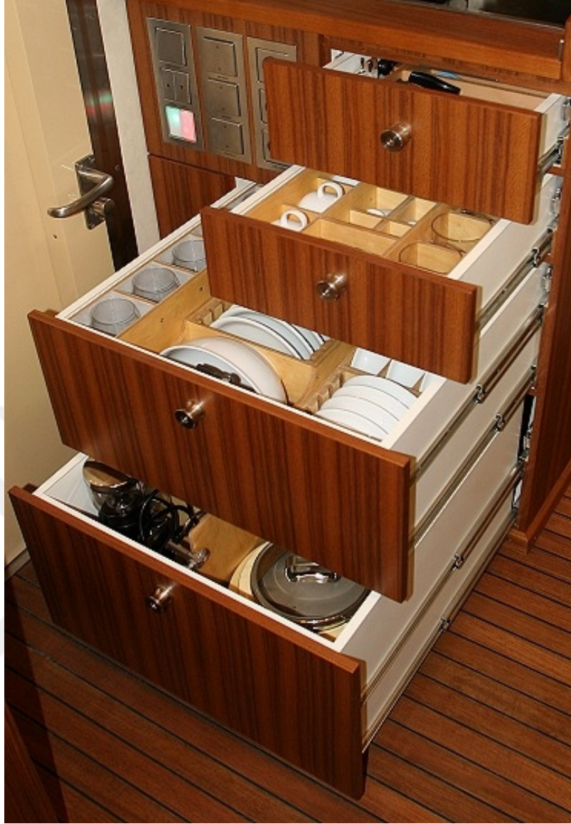
Görsel 4. 36. Bir deniz aracı mutfağında tencere, tabak ve bardaklar için özel olarak bölümlendirilmiş kilit kızaklı depolama üniteleri ( http-101 ).
