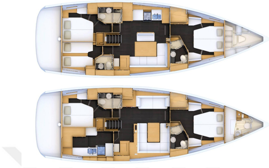
Şekil 4. 8. Jeanneau Yachts 54 modeli için Philippe Briand tarafından tasarlanan U ve L oturma birimli iki alternatif iç mekân tasarımı ( http-83 ).
