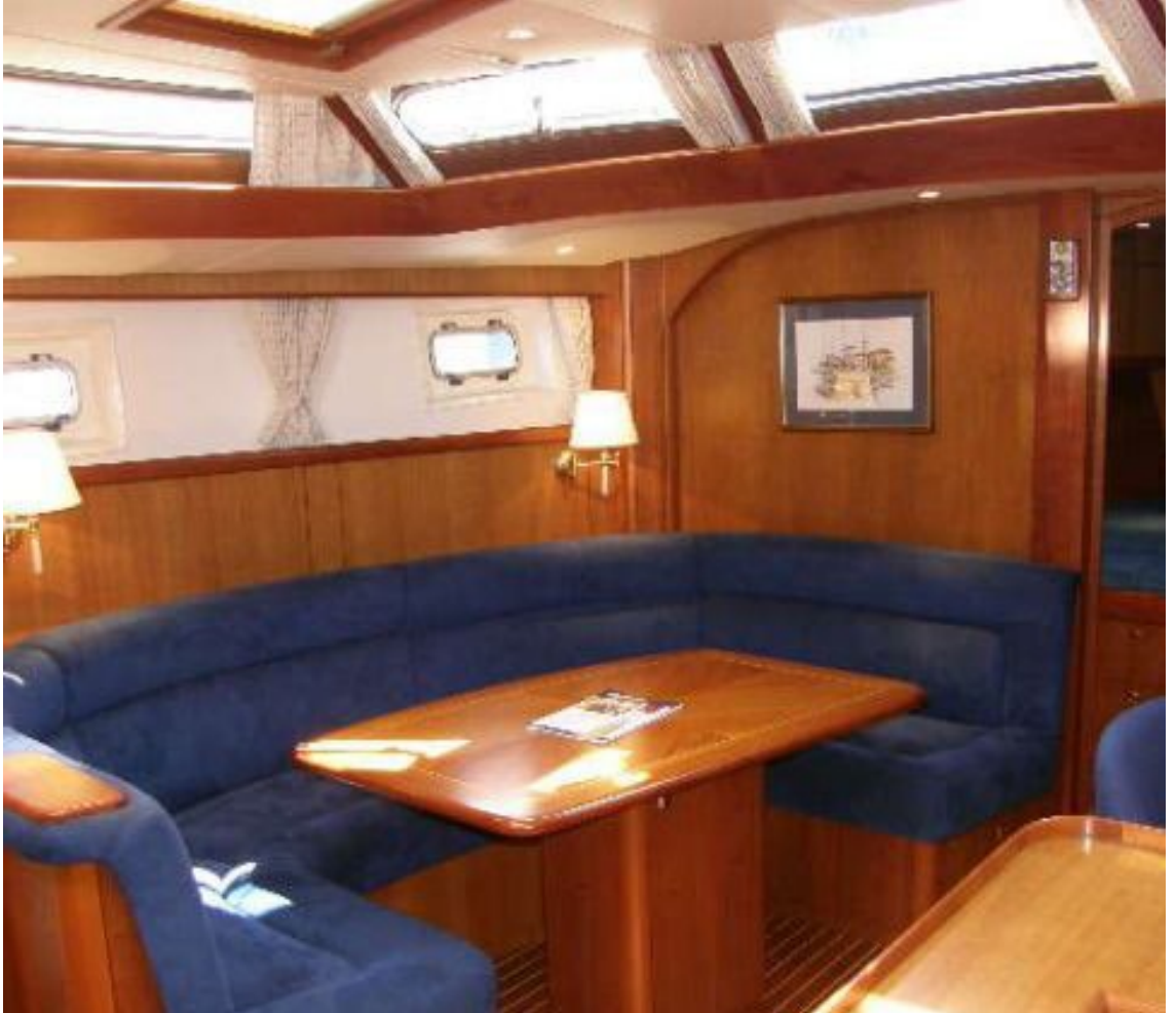
Görsel 4. 25. Nordia 50 Ketch, yelkenli deniz aracında lombozlar, heç ve sabit camlarla oluşturulan iç mekân aydınlatması ( http-88 ).
