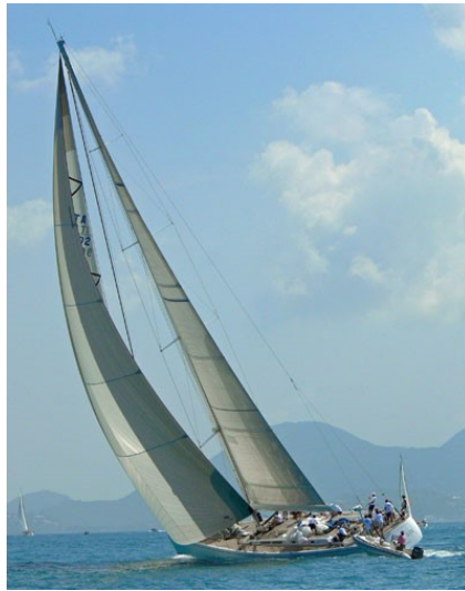
Görsel 2. 7. Seyir halinde şalopa (sloop) arma donanımlı bir yelkenli ( http-46 ).
