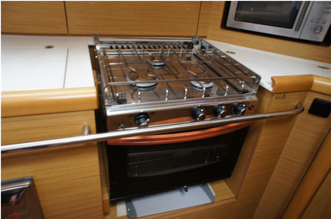
G rsel 4. 32. Jeanneau Yachts, 49' Sun Odessey DS Modeli seyir durumundayken askı sistemi  zerinde geriye doėru a ılanmıř ocak sistemi (http-97).
