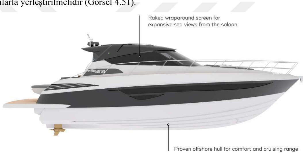
Görsel 4. 51. Focus Motoryachts, Power 50 modeli, yansımayı önlemek amacıyla açılı yerleştirilmiş dümen istasyonu camları ( http-l20 ).
