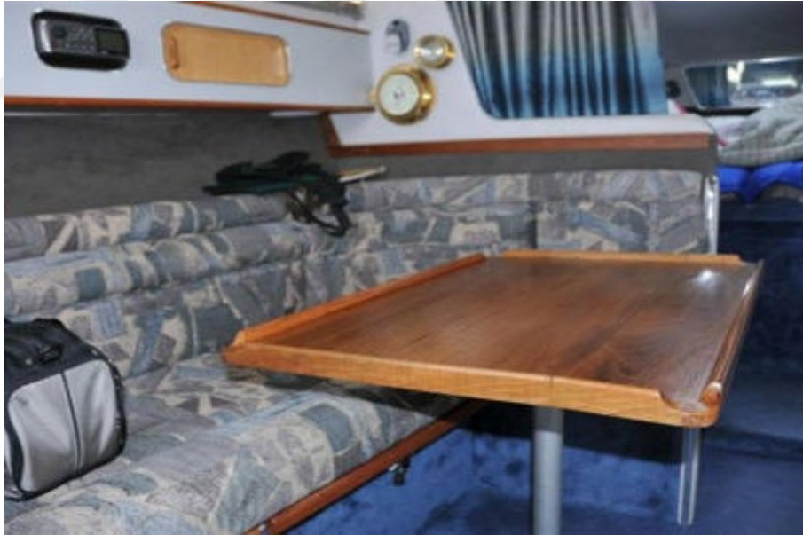
Görsel 4. 22. Üzerindeki eşyaları korumak için masa kenarlarına yapılan korkuluk uygulaması (http-85).
