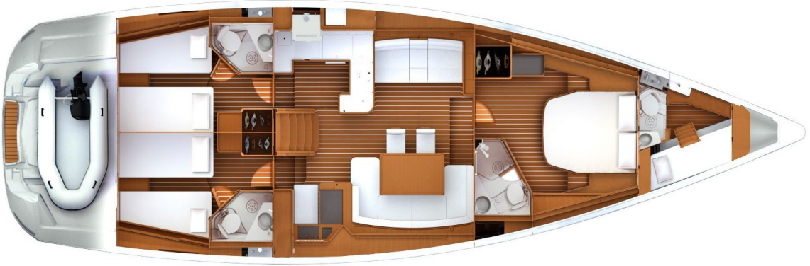
Şekil 4. 12. Jeanneau Yachts 57 Modeli “G” tipi mutfak planı ( http-92 ).
