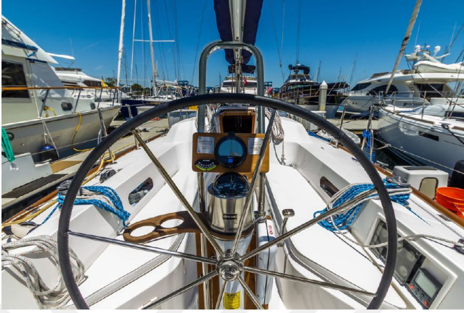
Görsel 4. 47. Bir deniz aracı kıç tarafında uygulanmış dolap dümen sistemi ( http-114 ).
