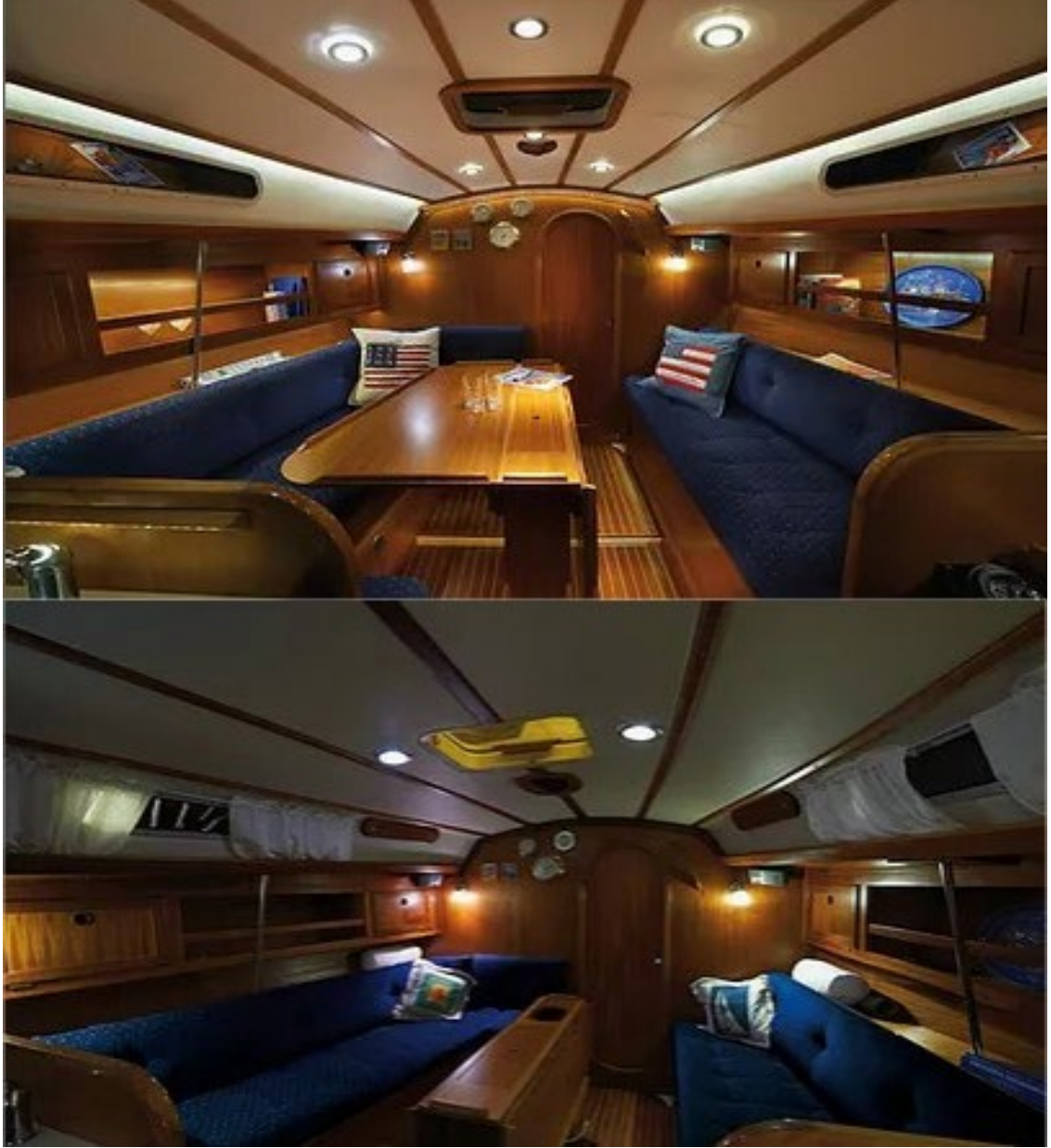
Görsel 4. 26. Yelkenli iç mekânında tavan aydınlatmaları ve aplikler ile doğrudan aydınlatma, alabanda yüzeyinden dolaylı aydınlatma örneği ( http-89 ).
