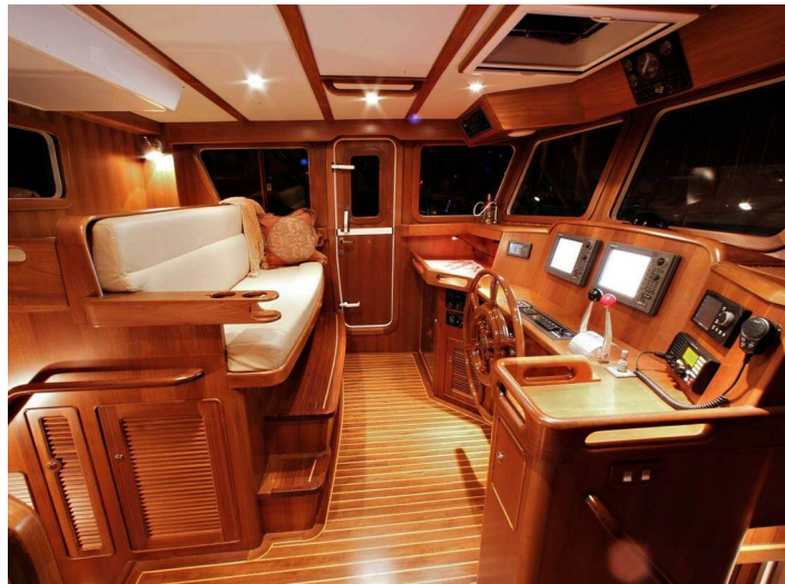
Görsel 4. 60. Selene Yachts, Selene 45 modeli, Kaptan köşkü olarak özelleşmiş bir iç mekân, harita masası (Solda), dümen istasyonu (Ortada) ve telsiz yer aldığı iletişim istasyonundan (Sağda) oluşan parça konsol ( http-131 ).
