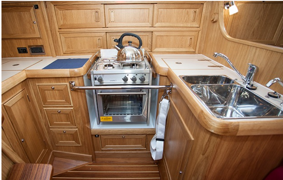
Görsel 4. 29. Deniz aracı mutfak mekânında ocak önüne yerleştirilmiş güvenlik profili ve kemer sistemi (http-94).
