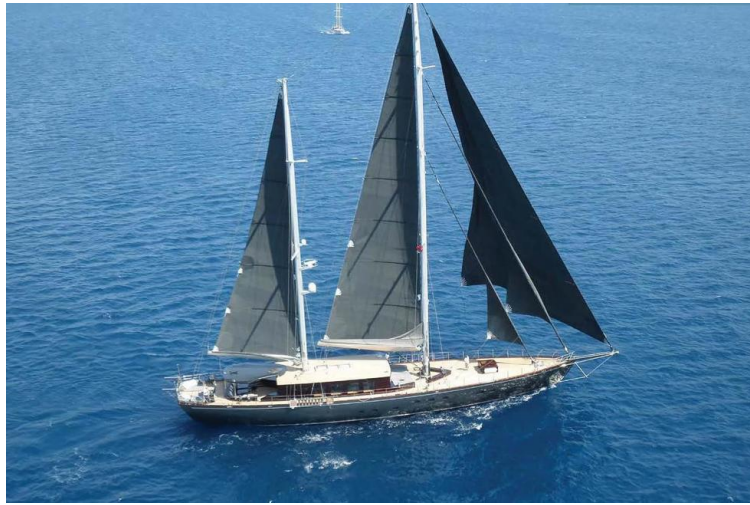
Görsel 2. 10. Seyir halindeki keç (ketch) arma donanımlı bir yelkenli ( http-49 ).
