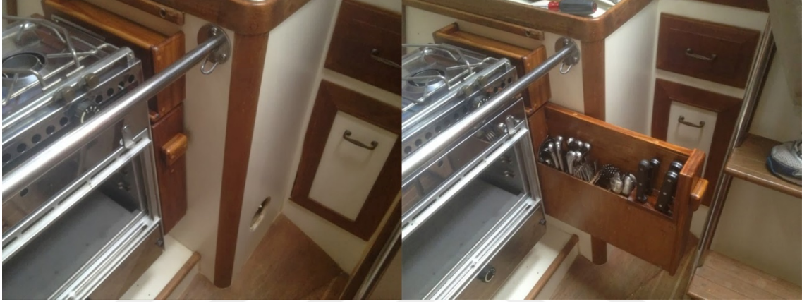
Görsel 4. 34. Bir deniz aracı mutfağında bıçak takımları için düzenlenmiş depolama ünitesi ( http-99 ).
