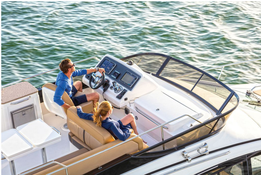
Görsel 4. 50. Motorlu deniz aracı üst güverte (flybridge) kısmında dümen istasyonu ( http-119 ).
