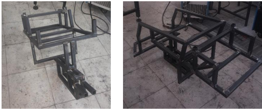
Şekil 4.26 KA şasi parçalarının kaynak ile birleştirildikten sonra bir bütün haline getirilmesi.
