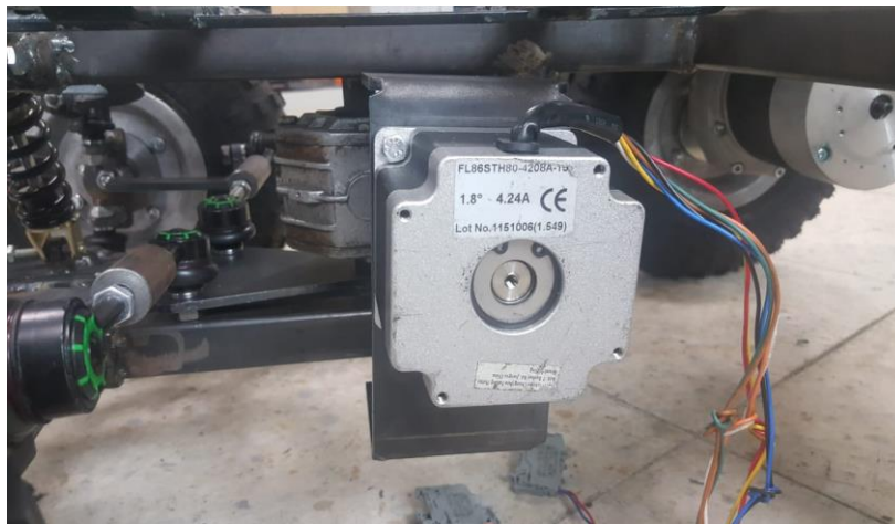
Şekil 4.31 Yönlendirme sistemi imalatı ve montajı.
