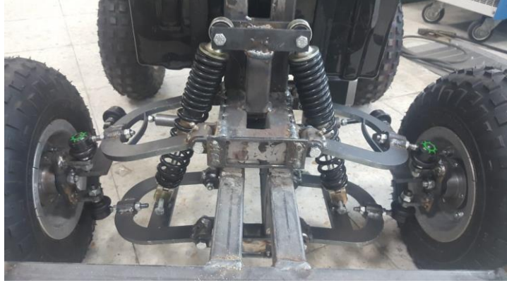
Şekil 3.6 Araçta kullanılan profil, sac ve yaylar.
