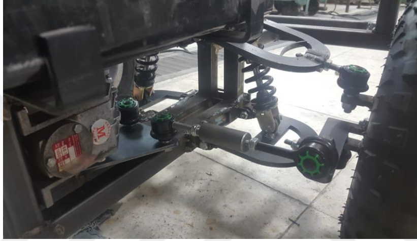
Şekil 4.30 Yönlendirme sistemi ile porya bağlantısı.
