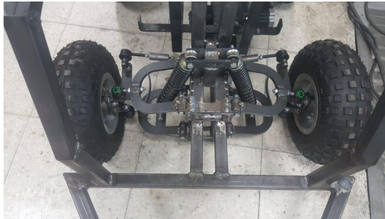
Şekil 4.27 Ön süspansiyon sistem imalatı ve montajı.
