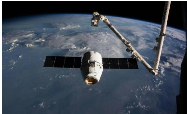
Şekil 2.5. Dragon'un canadarm (CSA) tarafından ele geçirilmesi.
