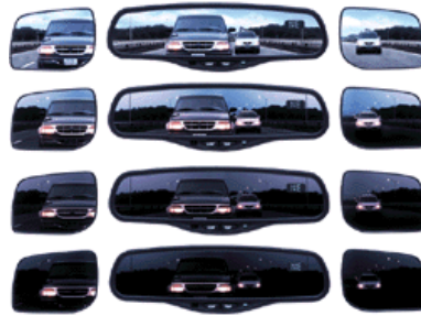
Şekil 2.8. Elektrokromik arka görüş (dikiz) aynalarında kararma
