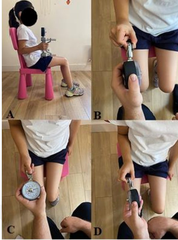
Şekil 3.6. El Dinamometresi ve Pinchmetre ile Kavrama Kuvvetlerinin Ölçülmesi (A= El Kavrama Kuvveti, B= Pinch Kavrama C= Lateral Kavrama D=Palmar Kavrama)
