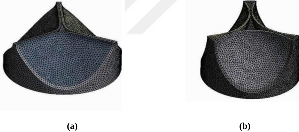
Şekil 2.8. Özgün polimerik aortik valf tasarımları için oluşturulan ağ (mesh) yapısı a) Gharaie ve Morsi’nin optimize valf tasarımı b) Burriesci ve arkadaşlarına ait referans valf tasarımı (Gharaie ve Morsi 2015)
