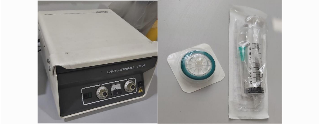
Şekil 3.8: ACM eldesi sırasında kullanılan santrifüj ve 0.22 µm por çaplı enjektör ucu steril filtre
