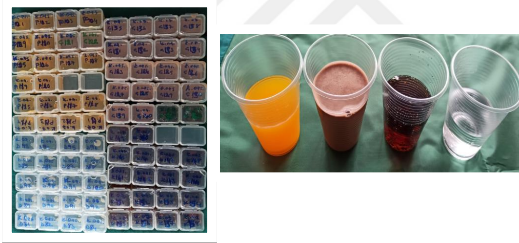
Şekil 3.6. Numunelerin solüsyonlara daldırılma prosedürü
