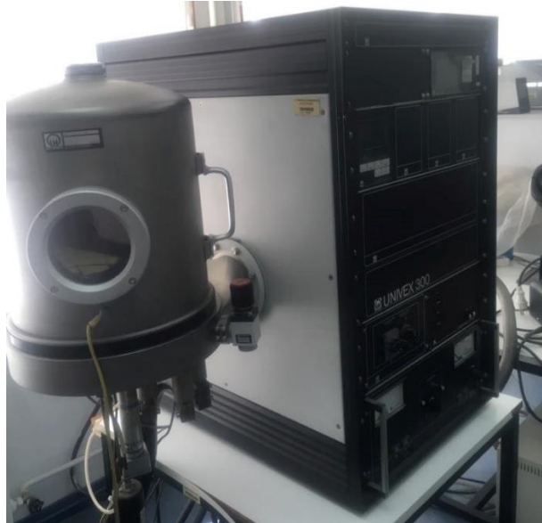
Görsel 4.1. Leybold-Heraeus 300 Univex System Au buharlaştırma cihazı
