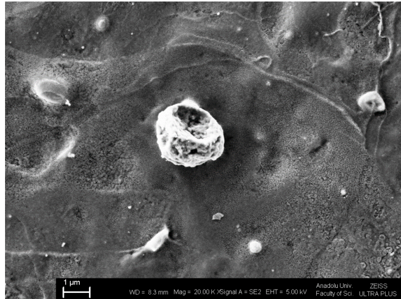
Şekil 5.26. Ultrasonik püskürtme yöntemiyle 300°C taban sıcaklığında FTO taban üzerine üretilen \text{Co}_3\text{O}_4 filminin FESEM görüntüsü
