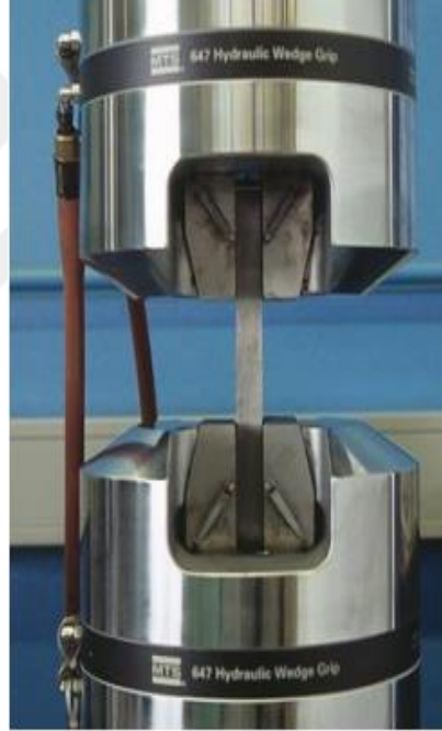
Şekil 4.7. Çekme test düzeneği
