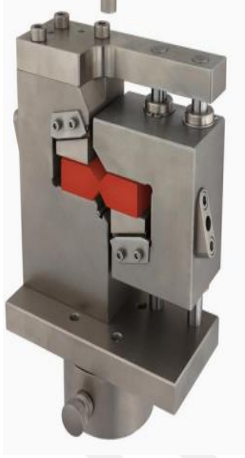
Şekil 4.8. V-Notch test düzeneği ve test numunesinin teknik resmi [40, 41]
