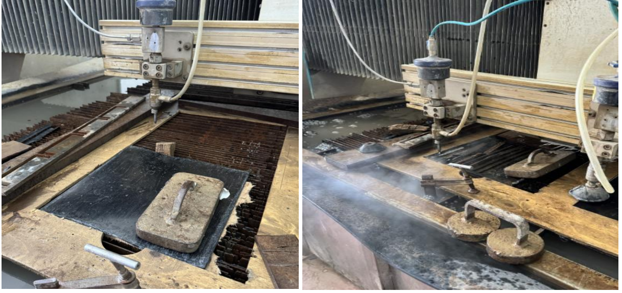
Şekil 4.4. Kompozit plakası ve su jetiyle plakalardan numunelerin kesilmesi
