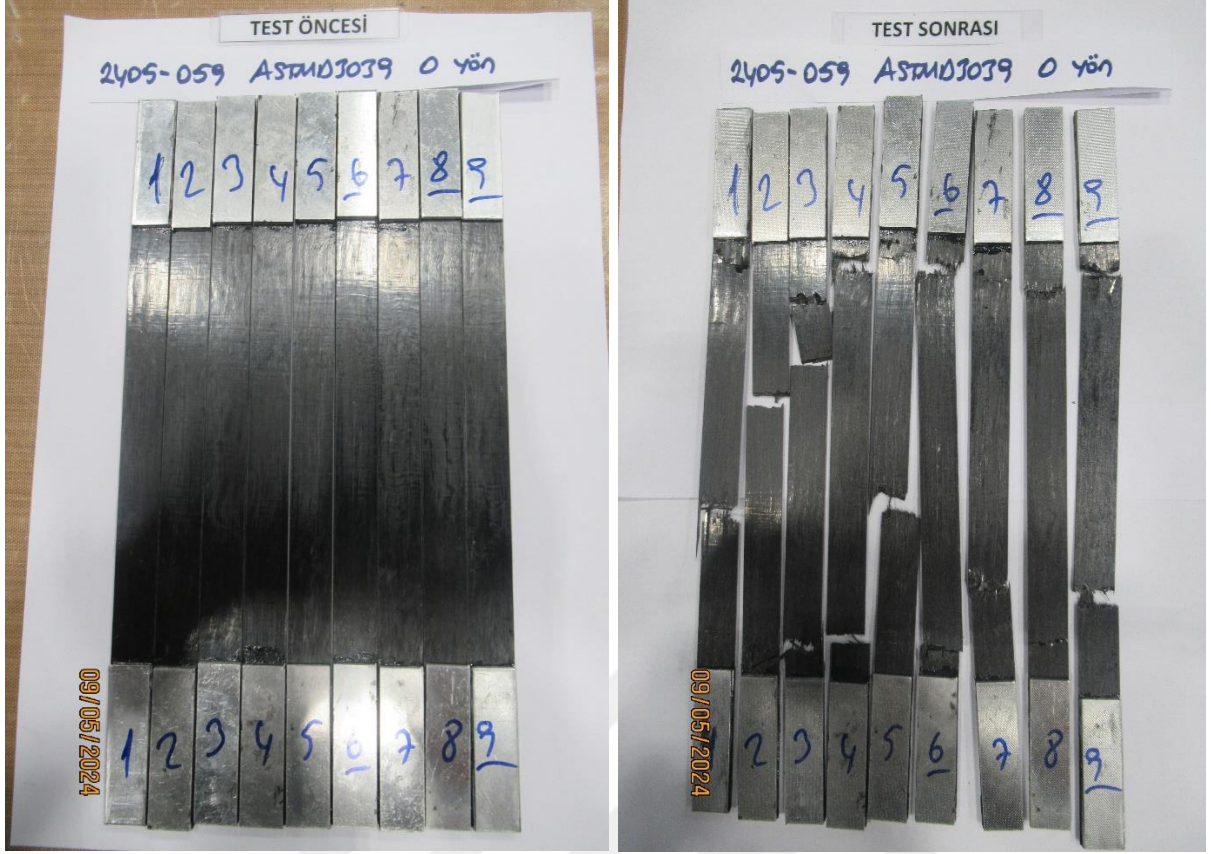
Şekil 5.2. 0^0 yönü çekme numunelerinin test öncesi ve sonrası
