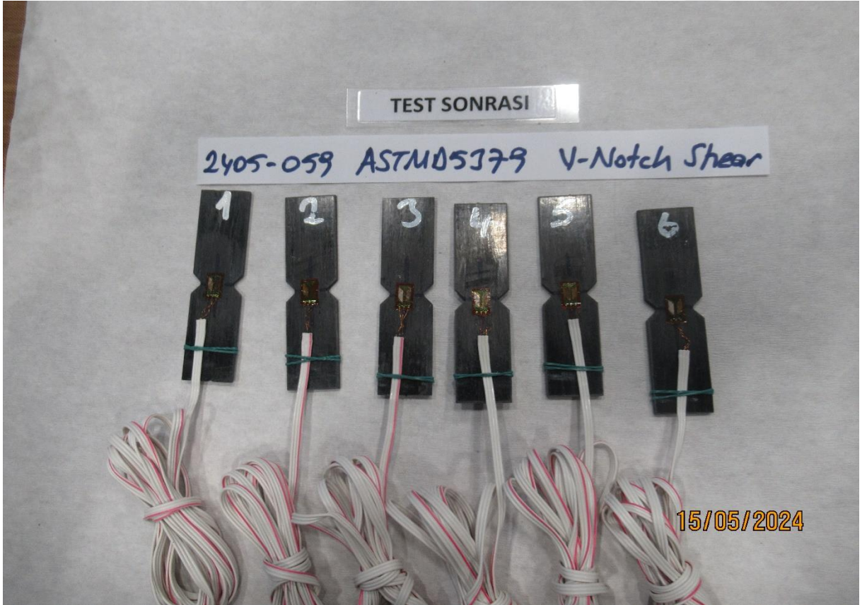
Şekil 5.10. Kayma numunelerinin test sonrası görseli
