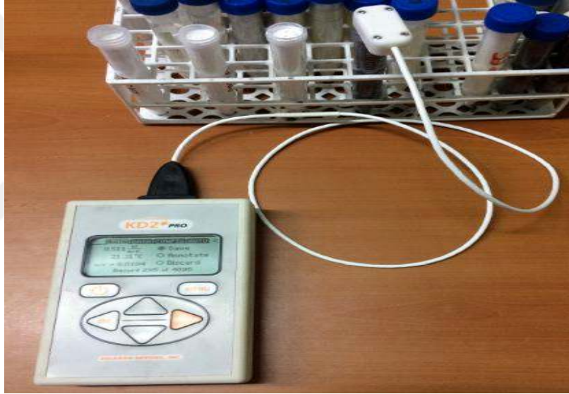
Şekil 12. Isıl iletkenlik ölçüm cihazı (Decagon KD2 Pro model)
