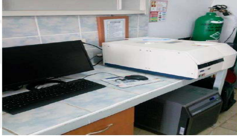
Şekil 9. DSC Cihazı (Hitachi-DSC 7020 Model)
