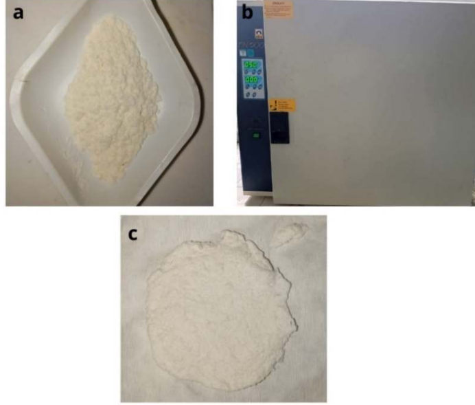
Şekil 11: (a) öğütülmüş ham selüloz, (b): kullanılan fırın, (c): kuruduktan sonra CMC
