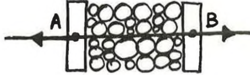
Şekil 21. Elastik deformasyon sırasındaki taneciklerin kayması
