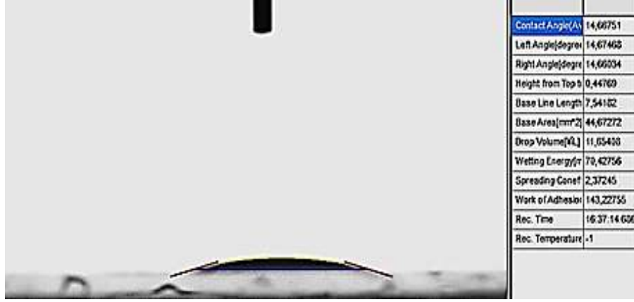
Şekil 3.28. Simitsonit mineraline ait temas açısı
