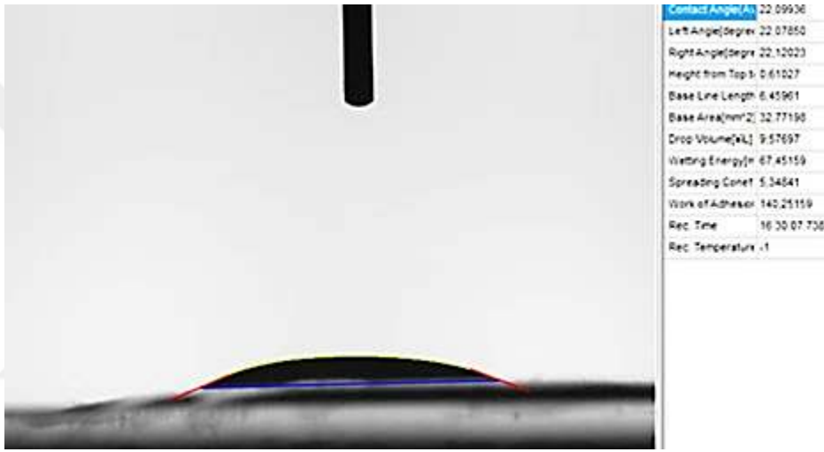
Şekil 3.26. Kalsit mineraline ait temas açısı
