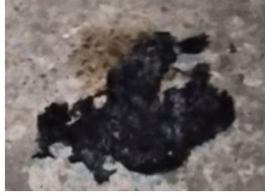
Şekil 3.33. Çapı 6 cm olan pamuk numunesinin yanma sonrası 11.Deney görseli.
