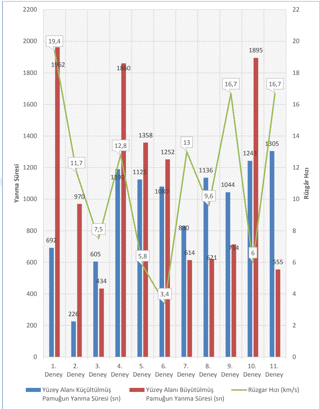
Şekil 3.29. Adana ilinde yüzey alanı büyütülmüş ve yüzey alanı azaltılmış olan pamuğun rüzgârın hızına bağlı yanma süreleri.
