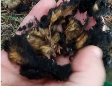
Şekil 3.20. 9.Deney yüzey alanı küçültülmüş pamuğun yanma sonrası görüntüsü.
