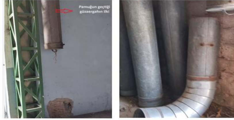
Şekil 1.6. Depodaki pamuğu ön temizleme ünitesinde kadar taşıyan pamuk emişi.
