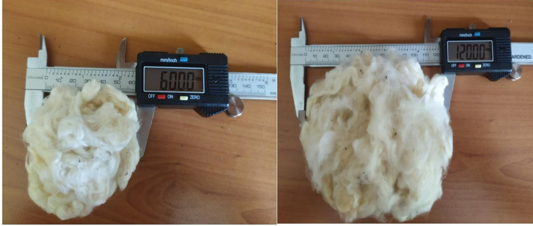
Şekil 3.6. Deney numune çaplarının ayarlanması.
