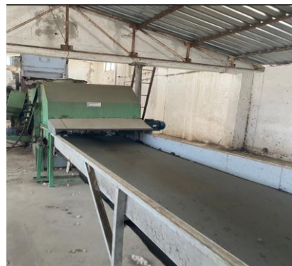
Şekil 1.8. Pamuėun temizleme nitesinden ıkıř yeri ve bant sistemi.
