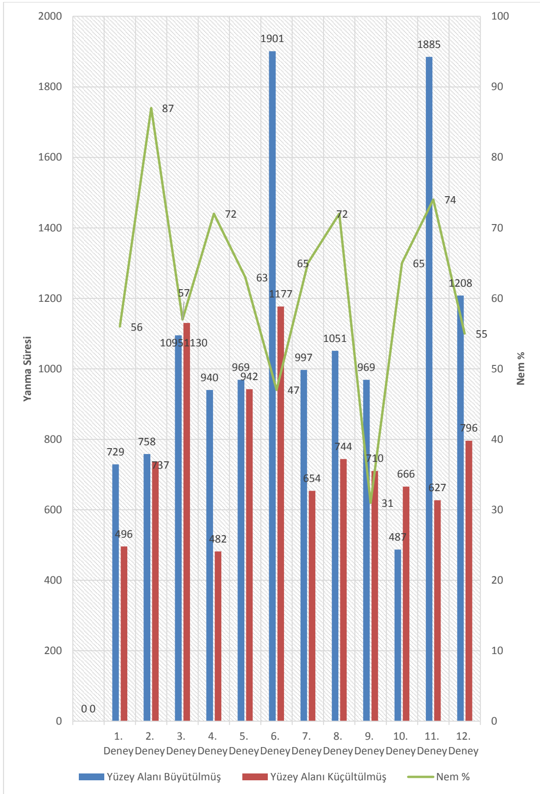
Şekil 3.9. İstanbul ilinde yüzey alanı büyütülmüş ve yüzey alanı azaltılmış olan pamuğun havanın nemine bağlı yanma süreleri.
