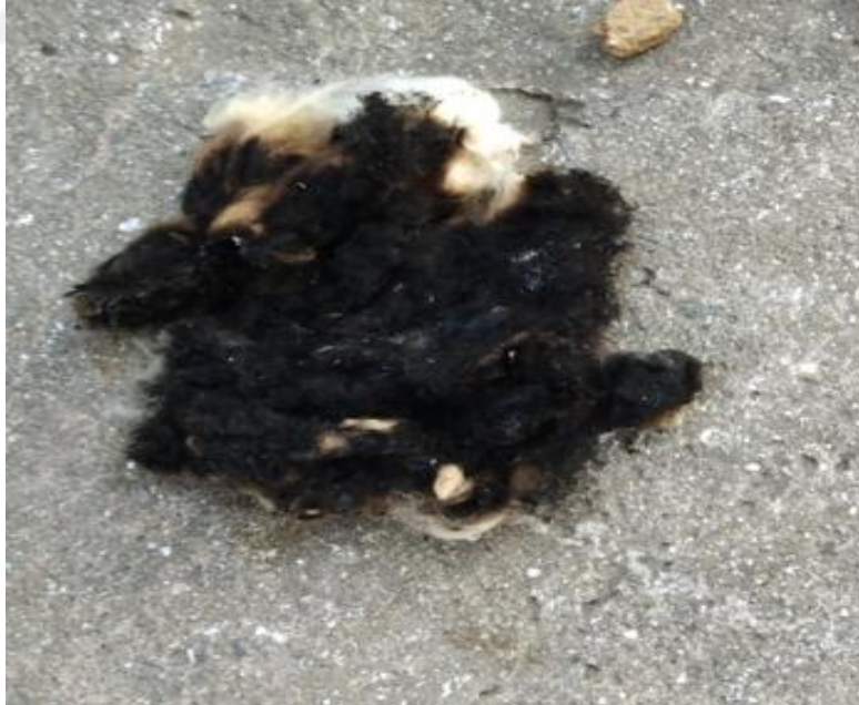
Şekil 3.25.12. Deney yanma sonrası yüzey alanı arttırılmış pamuk numunesi görseli.
