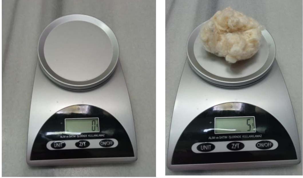
Şekil 3.4. Pamuk numunelerinin 5'er gr. olarak hassas terazi ile ölçülmesi.
