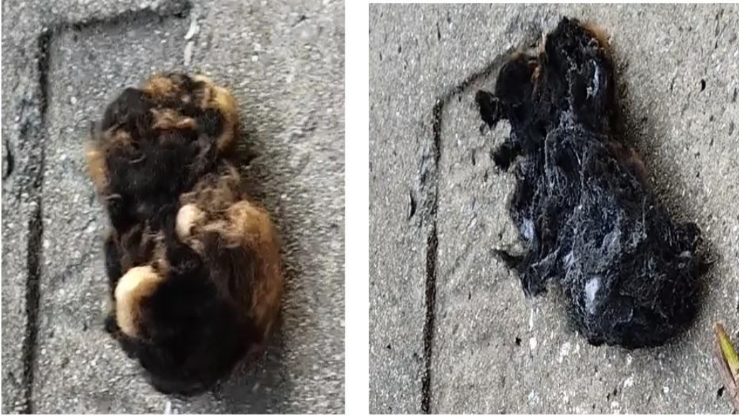
Şekil 3.24. Yüzey alanı azaltılmış olan pamuk ve yanma sonrası iç görseli.
