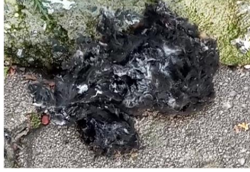
Şekil 3.20. 9.Deney yüzey alanı küçültülmüş pamuğun yanma sonrası görüntüsü.
