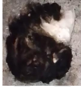
Şekil 3.30. Çapı 12 cm olan pamuk numunesinin yanma sonrası 9.Deney görseli.
