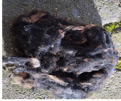
Şekil 3.15. 6.Deney yüzey alanı küçültülmüş olan pamuğun yanma sürecini tamamlamasının akabinde deney anında alınmış olan görsel.
