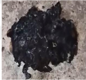
Şekil 3.31. Çapı 12 cm olan pamuk numunesinin yanma sonrası 9.Deney görseli.
