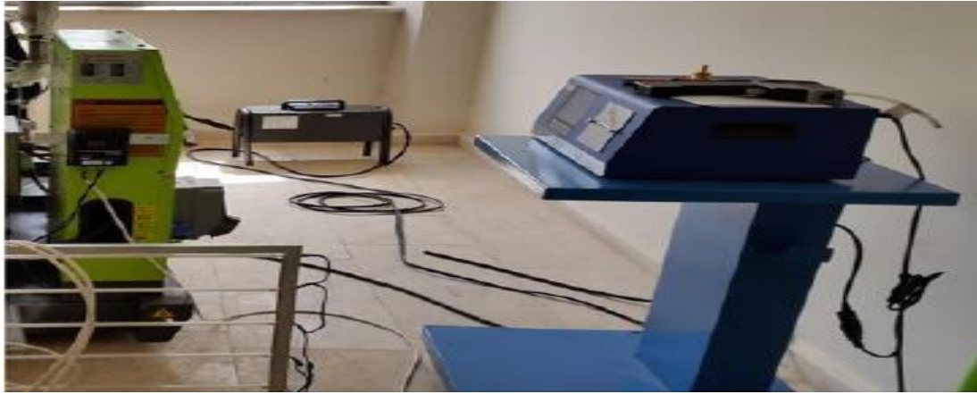
Şekil 3.2. Egzoz emisyon ölçüm cihazı
