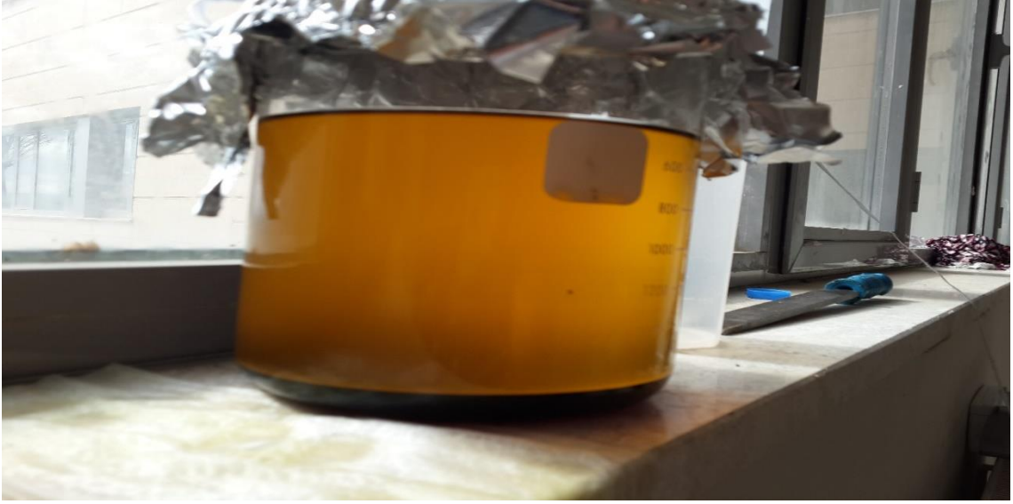
Şekil 3.10. Biyodizelde iki faz oluşumu
