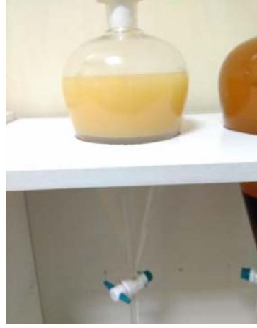
Şekil 5.15. Biyodizel yakıtının yıkanması ve Ph'nın ayarlanması.
