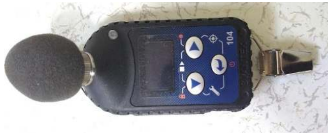
Şekil 5.10. Svantek 104 marka gürültü ölçüm cihazı.
