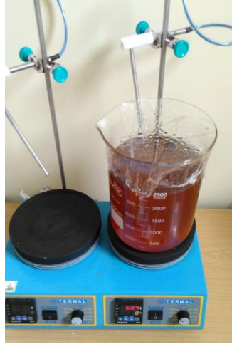
Şekil 5.12. Pamuk yağı 60°C'ye kadar ısıtılması.
