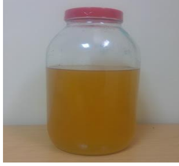
Şekil 5.17. Transasterifikasyon yöntemi ile üretilen pamuk yağı biyodizel yakıtı.
