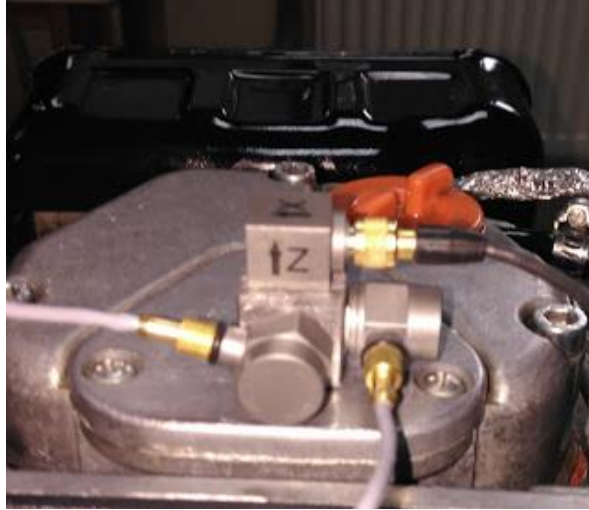
Şekil 5.9. Üç eksenli (X, Y ve Z) veri alınan ivmeölçerler.
