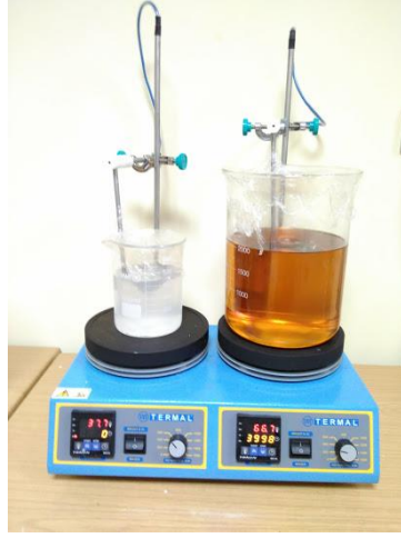
Şekil 5.13. Metanol ve NaOH'ın 37 °C'de karıştırılma işlemi.
