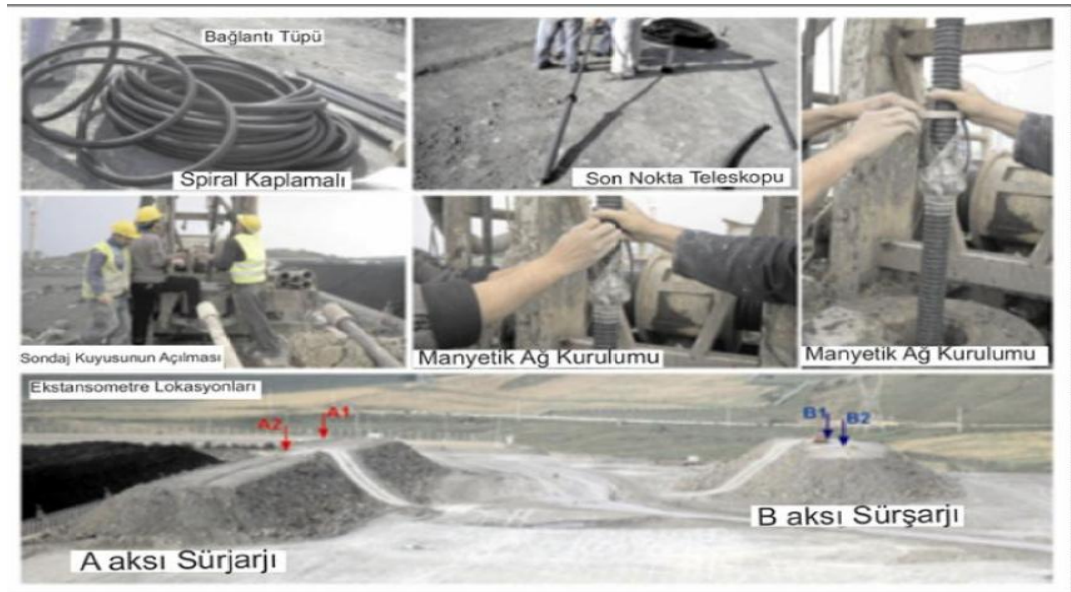
Şekil 4.4: Manyetik Ekstansometrenin arazide Uygulanması (Coşar 2010)
