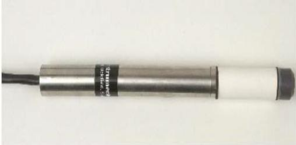
Şekil 4.3 : Pamukçay Barajında Kullanılan Titreşen Telli piyezometre (Çetin ve ark. 2016)
